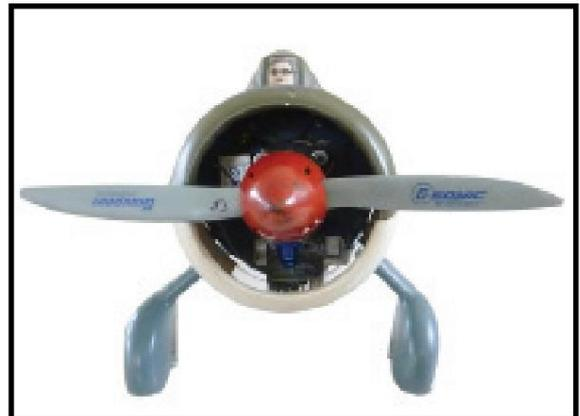
⚠ L'hélice ne doit toucher aucune partie du cône tournant. Si c'est le cas, utilisez un couteau à modeler bien aiguisé et coupez soigneusement le cône rotatif à l'endroit où l'hélice entre en contact avec lui.
