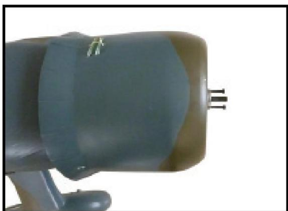
En raison de la taille du capot, il peut être nécessaire d'utiliser une rallonge de vanne à pointe pour la vanne à pointe haute vitesse. Fabriquez-le avec un fil de 1,5 mm de longueur suffisante et installez-le à l'extrémité de la vanne à pointe. Fixez le fil en place en serrant la vis de réglage sur le côté de la vanne à pointe.
