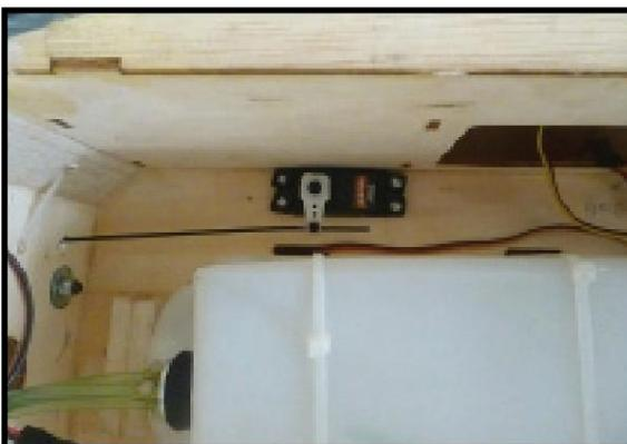
Déplacez le manche des gaz en position fermée et déplacez le carburateur en position fermée. Utilisez une clé hexagonale de 2,5 mm pour serrer la vis qui fixe le fil de la tige de poussée de l'accélérateur. Assurez-vous d'utiliser du frein-filet sur la vis afin qu'elle ne vibre pas.
