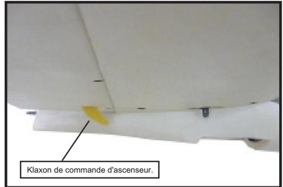
3) Vissez une chape et un contre-écrou M3 sur chaque tige de commande d'ascenseur. Enfilez les cornes jusqu'à ce qu'elles affleurent les extrémités des tiges de commande.
