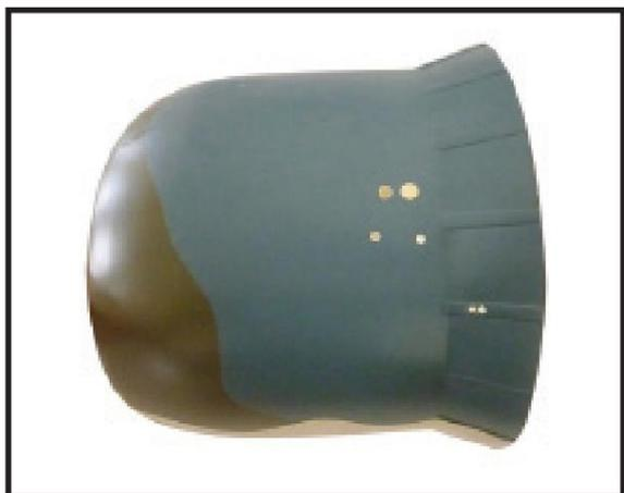
1) Faites glisser le capot en fibre de verre sur le moteur et alignez le bord arrière du capot avec les marques que vous avez faites sur le fuselage, puis coupez et coupez comme indiqué.
