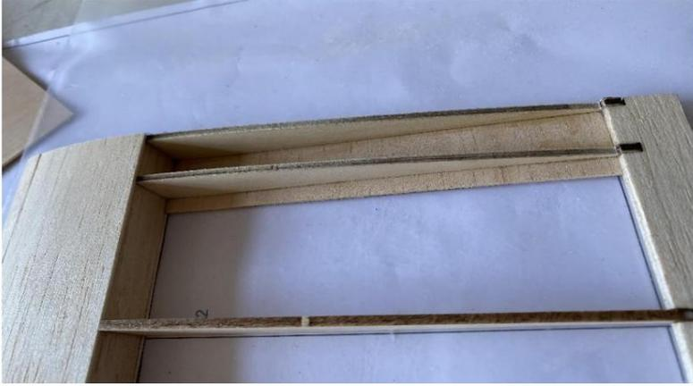
4) Collez 3 morceaux d'A36 en un seul morceau et remplissez-les au milieu de la nervure de l'aile A1 avec de la colle à bois et collez le revêtement supérieur. (3 pièces d'A36 sont utilisées comme renfort pour fixer les vis plus tard)
