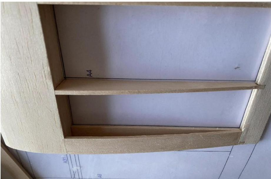
6) Assemblez la nervure médiane de l'aile et la plaque d'aile, puis collez le bord de fuite de l'aile.
