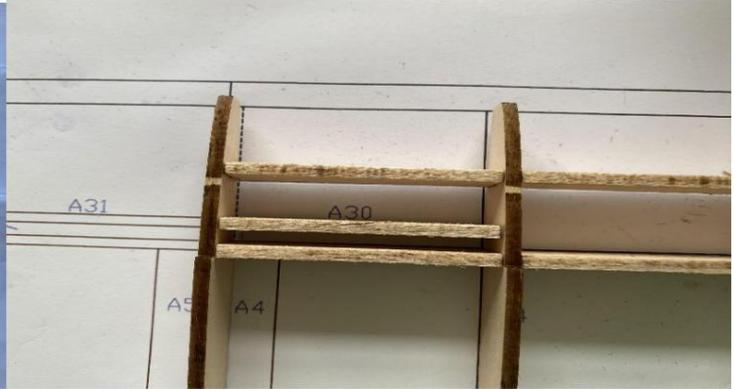
2) Collez les revêtements supérieurs et inférieurs de l'aile, collez des bandes de balsa de 8 x 12 mm sur le bord d'attaque de l'aile et polissez-les.
