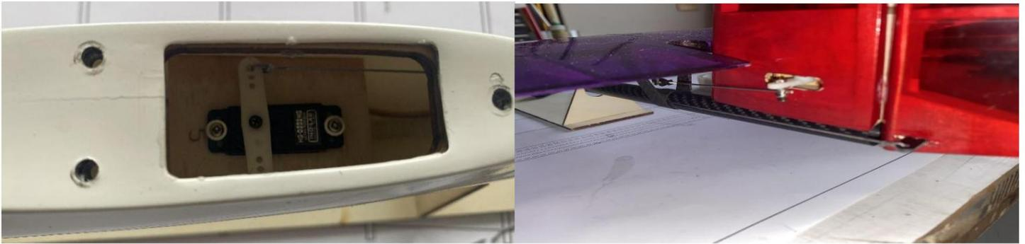
7) Fixez un fil d'acier de 1,2MM avec de la colle époxy au milieu du couvercle de cabine en carbone (utilisé comme clips).
