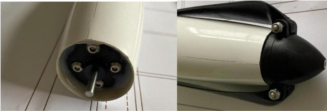
2) Positionnez le trou avec le gabarit, installez les écrous en T sur le contreplaqué B24 à l'intérieur du fuselage et fixez-les au corps avec de la colle époxy. (De l'amidon ou d'autres substances peuvent être ajoutées à la colle résine pour réduire la fluidité de la colle. )
