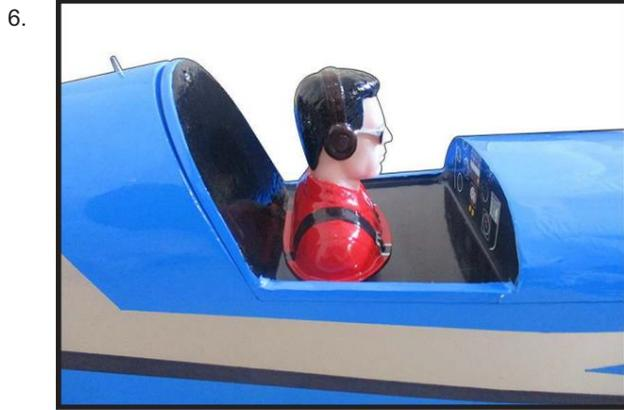
Auvent époxy sur le fuselage. Tracez le contour de la verrière et sur le fuselage à l'aide d'une époxy.
