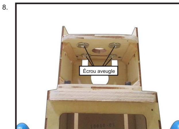
Fixez le moteur à l'avant du boîtier du moteur électrique à l'aide de quatre écrous borgnes de 4 mm et de quatre boulons à tête hexagonale M4x20 mm pour fixer le moteur. Veuillez voir l'image affichée.
