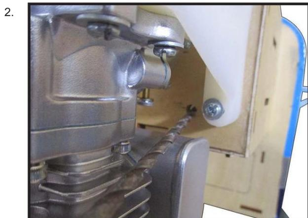
Fixez la tige de poussée de l'accélérateur au carburateur. tor papillon des gaz avec la rotule.
