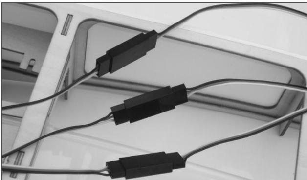
2. Branchez le fil unique du faisceau de câbles dans l'engrenage canal de votre récepteur. Un canal auxiliaire peut être utilisé si le canal de vitesse est occupé.
