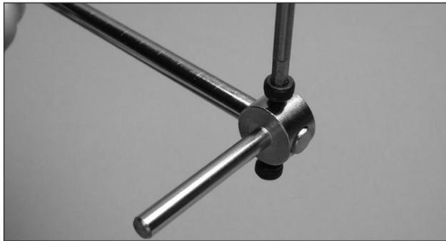
4. Installez les roues sur les essieux. Faites glisser le collier de roue en laiton sur l'axe et fixez-le à l'aide d'une clé hexagonale de 1,5 mm.
