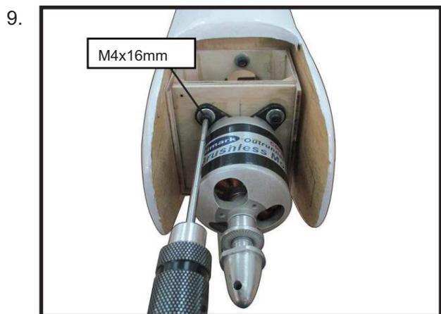
Localisez le plateau de batterie en contreplaqué sur le fuselage. Serrez les vis à l'aide de vis à métaux M4x16mm pour fixer le plateau en position.
