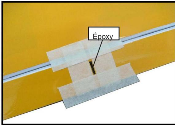
Appliquez de l'époxy sur la zone des cornes de commande qui se trouve dans les fentes. Utilisez suffisamment d'époxy pour que les cornes de commande soient entièrement collées aux surfaces ied.
