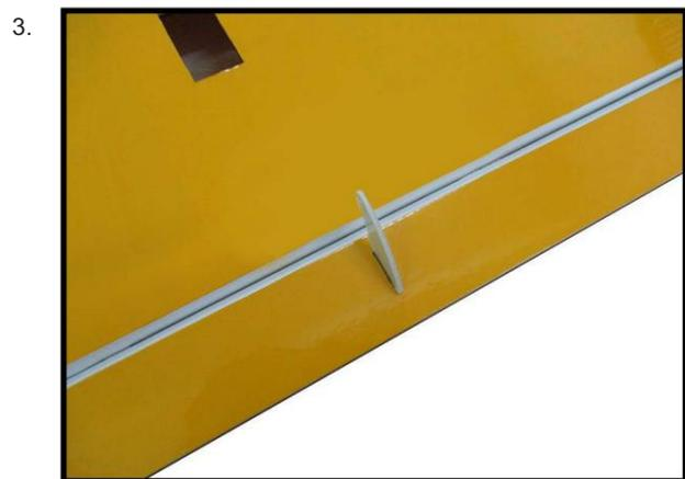
Placez du ruban adhésif à faible adhérence à 1/32 pouce (1 mm) de la fente du klaxon de commande. Cela empêchera l'époxy de pénétrer sur la gouverne lorsque les klaxons de commande sont collés en place.
