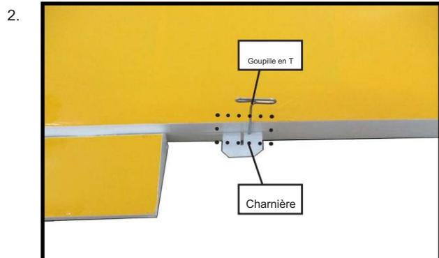
Faites glisser le panneau d'aile sur l'aileron jusqu'à ce qu'il n'y ait qu'un léger espace. La charnière est désormais centrée sur le panneau d'aile et l'aileron. Retirez les goupilles en T et serrez l'aileron contre le panneau d'aile. Un espace de 1/64" ou moins doit être maintenu entre le panneau de l'aile et l'aileron.
