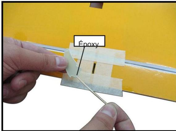
Avant que l'époxy ne durcisse complètement, retirez le ruban adhésif autour du klaxon de commande. Cela permettra à l'époxy de couler autour du cornet de commande, créant un petit îlot entre le cornet de commande et la surface pour un aspect fini et une liaison sécurisée.
