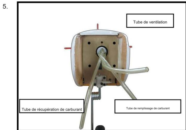
Connectez les conduites du réservoir au moteur et au muler. La conduite de ventilation se connectera au muler et à la conduite allant du clnk au carburateur.
