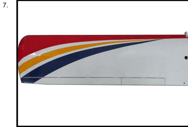
fois Faites monter et descendre l'aileron plusieurs fois pour « travailler » les charnières et vérifier le bon mouvement.
