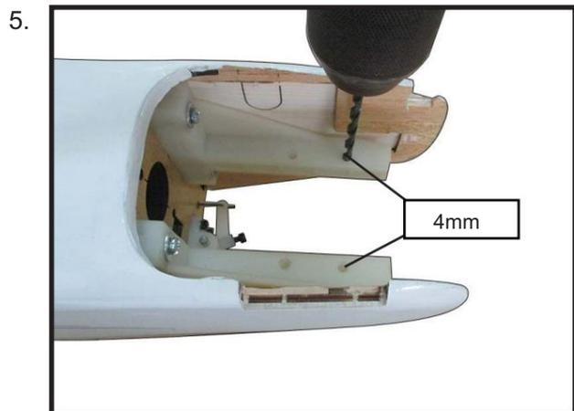
Sur le mur ie se trouve l'emplacement pour le tube de tige d'accélérateur (pré-perçage).
