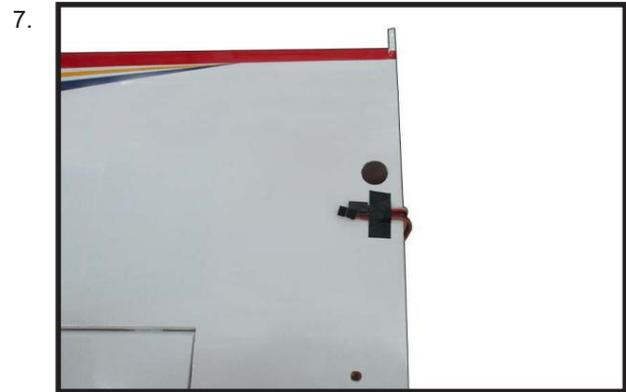
Réinstallez le servo dans le support de servo et fixez le servo en place à l'aide des vis à bois fournies avec votre système radio.
