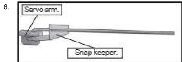
Connectez la tringlerie comme indiqué et fixez le fil de commande avec un dispositif de retenue.
