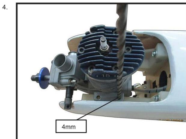
Utilisez une perceuse pour percer les quatre trous dans le rails de support moteur.
