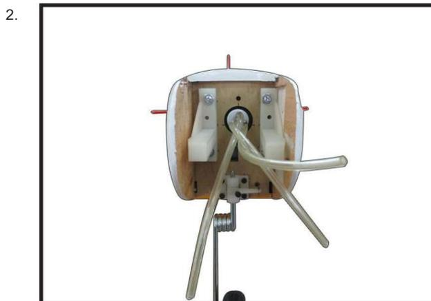
Positionnez le moteur avec la rondelle d'entraînement (135 mm) en avant du mur pare-feu, comme illustré.
