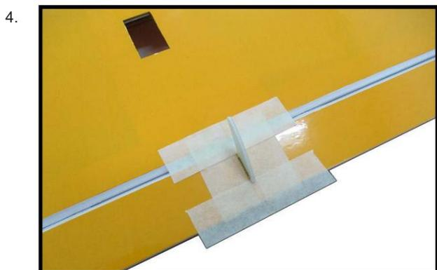
Retirez les guignols des gouvernes. Appliquez de l'époxy sur la fente de l'aileron et sur le recouvrement. Assurez-vous que l'époxy pénètre dans la fente pour une bonne liaison entre les surfaces et le klaxon de commande.
