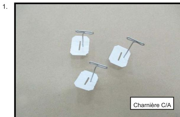
Retirez chaque charnière du panneau d'aile et de l'aileron et placez une goupille en T au centre de chaque charnière. Faites glisser chaque charnière dans le panneau de l'aile jusqu'à ce que la goupille en T soit bien ajustée contre l'aile. cela contribuera à assurer un montant égal de la charnière se trouve de chaque côté de la ligne de charnière lorsque l'aileron est monté sur l'aileron.
