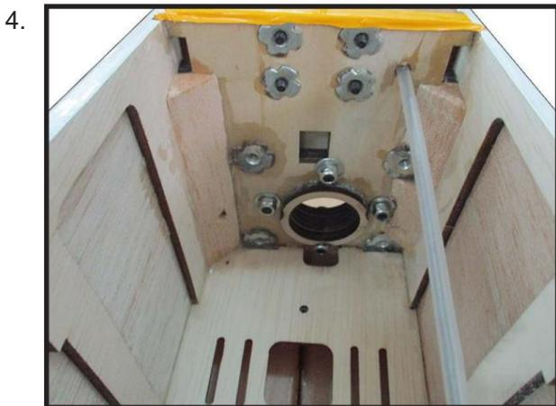
Fixez le moteur à l'avant du boîtier du moteur électrique à l'aide de quatre stores de 4 mm. écrou, quatre boulons à tête hexagonale M4x16 mm pour fixer le moteur. Veuillez voir l'image affichée.
