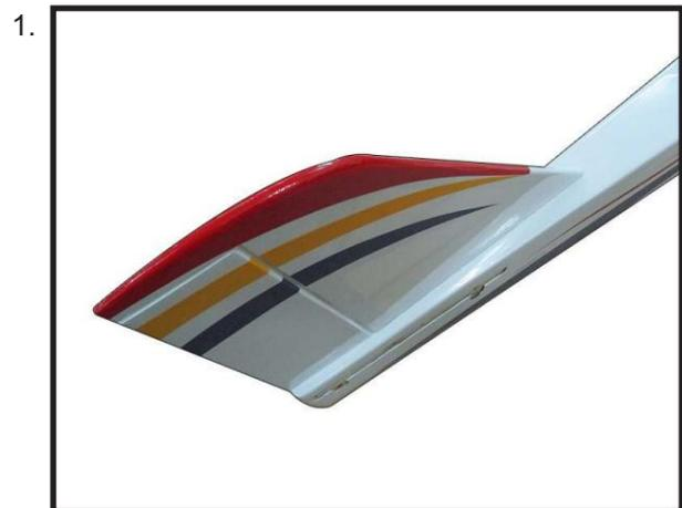
Tout en maintenant fermement le stabilisateur vertical en place, utilisez un stylo et tracez une ligne de chaque côté du stabilisateur vertical à l'endroit où il rencontre le haut du fuselage.
