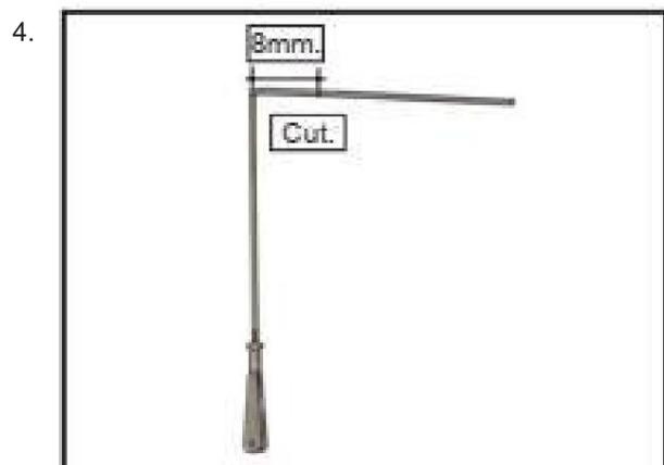
Faites un coude à 90 degrés au niveau de la marque et coupez l'excédent de fil en laissant 8 mm au-delà du coude.
