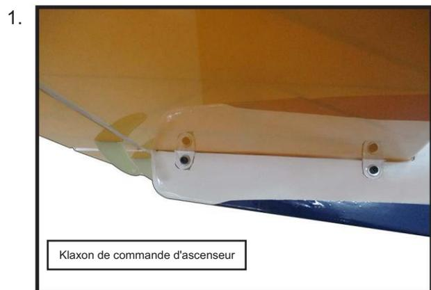
Vissez une chape et un contre-écrou M2 sur chaque tige de commande d'ascenseur. Enfilez les cornes jusqu'à ce qu'elles soient en contact avec les extrémités des barres de commande.
