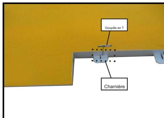
Faites glisser le panneau d'aile sur les genoux jusqu'à ce qu'il n'y ait qu'un léger espace. La charnière est maintenant centrée sur le panneau d'aile et sur le recouvrement. Retirez les broches en T et serrez le recouvrement contre le panneau de l'aile. Un espace de 1/64" ou moins doit être maintenu entre le panneau d'aile et le recouvrement.
