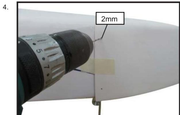
Installez le Muler et l'extension Muler sur le moteur et faites la découpe dans le capot pour le dégagement du Muler. Connectez les conduites de carburant et de pression au carburateur, au collecteur et à la valve de remplissage de carburant. Fixez le capot au fuselage à l'aide des vis à tête creuse M3x10 mm. Placer une petite longueur de tube de carburant en silicone sous la tête de la vis aide à réduire les vibrations.
