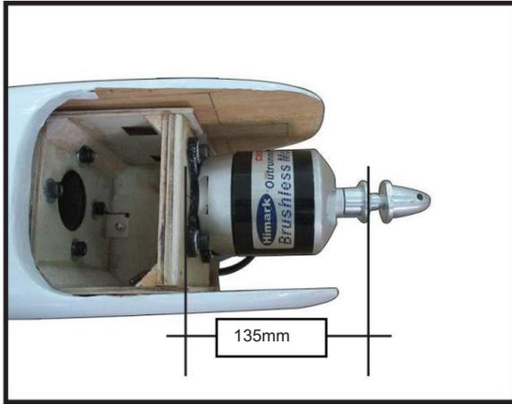
Fixez le contrôle de vitesse sur le côté du boîtier moteur à l'aide de ruban adhésif double face et d'attaches. Connectez les fils appropriés du contrôle de vitesse au moteur. Assurez-vous que les câbles n'interféreront pas avec le fonctionnement du moteur.
