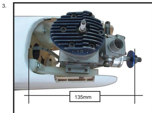
Utilisez une perceuse à goupille et un foret de 4 mm pour percer une petite empreinte dans le support pour le vis de fixation du moteur.
