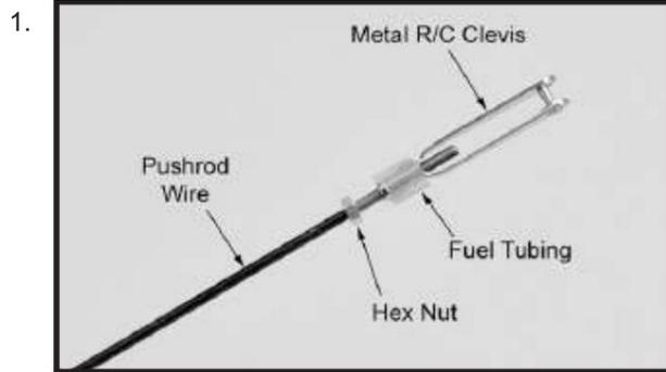
Utilisez un stylo-feutre pour marquer le fil à l'endroit il traverse le trou. Utilisez une paire de pinces pour faites un coude à 90 degrés dans le fil à la marque.
