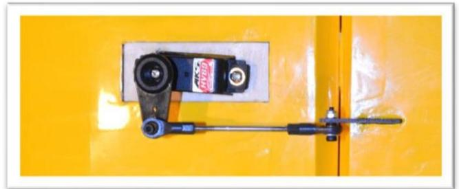
Localisez soigneusement les trous de montage dans les générateurs de force latéraux et coupez le revêtement. Les bouts d'ailes ont un écrou borgne installé sous le revêtement. Utilisez un couteau de loisir pour couper le revêtement. (Utilisez les trous d'une plaque d'espacement pour vous aider à localiser les trous du bout de l'aile.)
