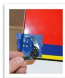
Vérifiez l'alignement du guignol de commande, en le centrant d'un côté à l'autre et en alignant les trous avec la ligne de charnière. Le klaxon de commande doit être symétrique par rapport à la ligne charnière.
