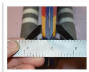
Positionnez le gouvernail et le guignol de commande de manière à ce que la gravité ne repositionne pas le guignol de commande pendant que l'époxy durcit.
