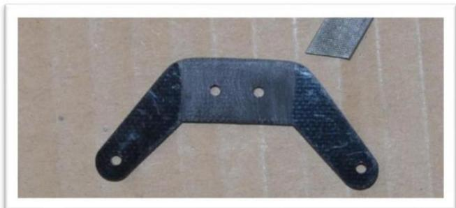
Tests pour ajuster le klaxon de commande à la fente. Utilisez un fichier pour modifier l'emplacement si nécessaire. Centrez-le d'un côté à l'autre et alignez les trous avec la ligne de charnière. Le klaxon de commande doit être symétrique par rapport à la ligne charnière.
