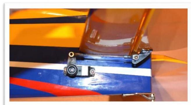
Ajustez la longueur de la bielle au bras de servo avec la profondeur alignée avec le stabilisateur. Lorsque la bonne longueur de l'assemblage est trouvée, connectez la boule lien vers le bras de commande de l'ascenseur à l'intérieur, comme illustré. (Ajustez toujours la longueur de la bielle avec le servo sous tension et centré.)
