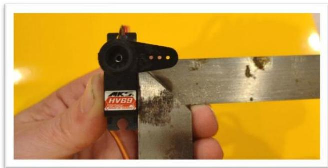
Fixez une extension de servo de 18 pouces sur le servo de profondeur câble et utilisez un clip de sécurité pour sécuriser la connexion.
