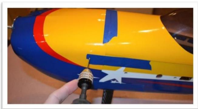
Retirez le capot et vissez les vis dans les trous du fuselage. Retirez les vis et ajoutez une goutte d'indice CA pour durcir le bois autour de chaque trou.
