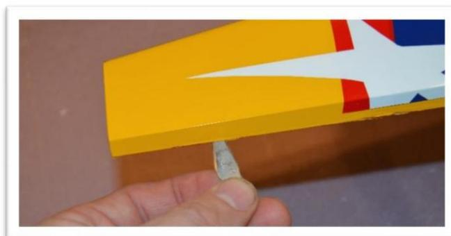
Testez l'ajustement de la plaque de jonction de l'ascenseur sur la moitié opposée de l'ascenseur. Assurez-vous que les moitiés de l'élévateur ne sont pas tordues. Prenez une moitié de l'élévateur en position et vérifiez l'alignement de l'autre côté. Vérifiez les espaces aux extrémités du stabilisateur. Ajustez la fente dans l'élévateur ou limez les bords de la plaque de dégauchisseuse si nécessaire pour obtenir un bon ajustement.
