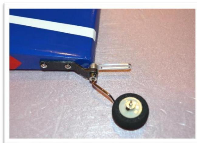
La troisième vis est utilisée pour fixer le bras de timon au gouvernail après son installation. Ne serrez pas complètement la vis du bras de barre. La fente dans le bras de barre permet au gouvernail de bouger librement.
