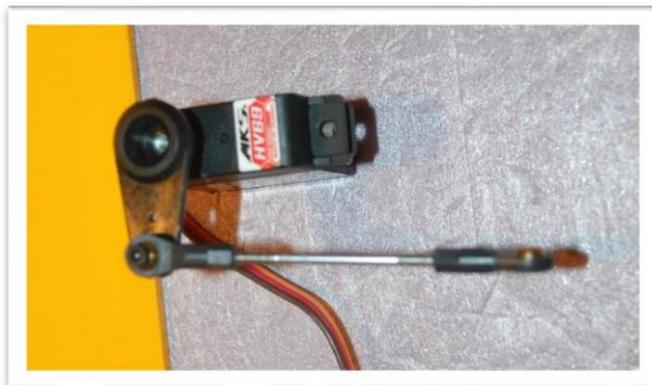
Vérifiez la longueur de l'ensemble jusqu'au bras de servo avec l'aileron au niveau de l'aile. Lorsque la bonne longueur de l'ensemble est trouvée, connectez la rotule au bras du servo. (Ajustez toujours la longueur de la bielle avec le servo sous tension et centré.)
