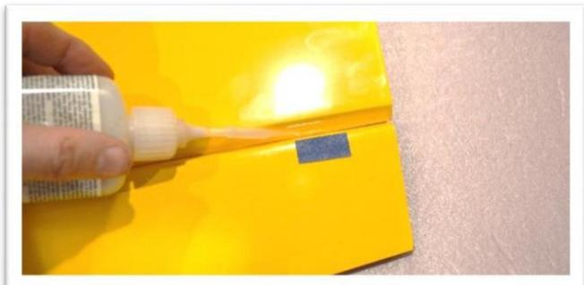
Comblez l'espace entre l'aileron et l'aile vers la position souhaitée à l'extrémité du fuselage de la moitié de l'aile. Fléchissez légèrement l'aileron et appliquez quelques gouttes de colle CA fine sur les deux côtés de la charnière. Déplacez à nouveau l'aileron d'avant en arrière jusqu'à sa position maximale. Une fois les charnières d'extrémité bien positionnées, vous pouvez appliquer quelques gouttes de CA mince sur les deux côtés des charnières restantes.
