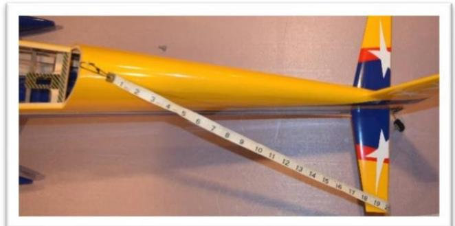
Une fois le stabilisateur horizontal positionné, collez-le en place avec de la colle CA fine. Mèche de colle sur les côtés gauche et droit, en haut et en bas. L'utilisation d'un embout applicateur est suggérée pour contrôler le débit de colle CA fine et l'amener exactement là où vous le souhaitez.
