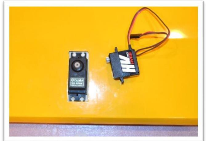
Insérez la plaque d'adaptation dans la poche du servo si vous utilisez le servo de taille micro. Vous devrez peut-être poncer légèrement les bords pour l'insérer. Le coin avant de la poche du servo doit être incliné à l'opposé du guignol de commande de l'aileron, comme illustré.
