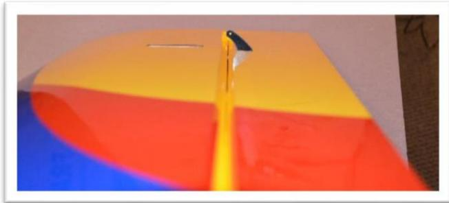
Laissez l'époxy durcir partiellement. Retirez le ruban de masquage une fois que l'époxy maintient solidement le klaxon de commande en place et est encore suffisamment souple pour retirer facilement le ruban.
