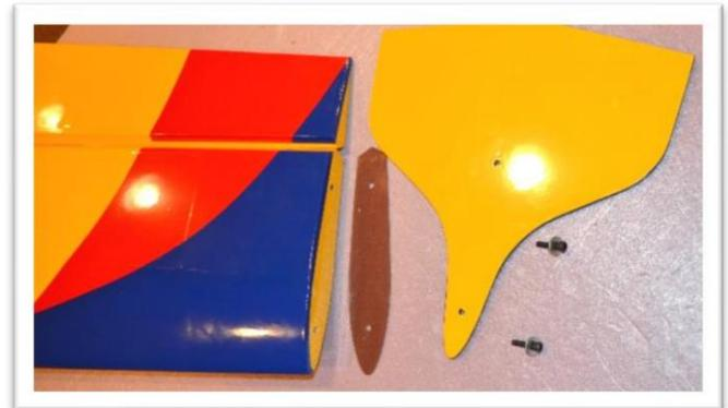
Assemblez la plaque d'espacement et le générateur de force latérale à l'aile avec les vis et rondelles de 3 mm fournies.
