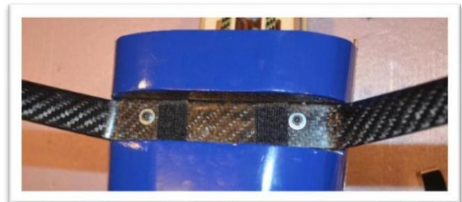
Ensuite, coupez ou poncez les évidements dans le bloc de remplissage pour s'adapter à l'épaisseur du ruban auto-agrippant.
