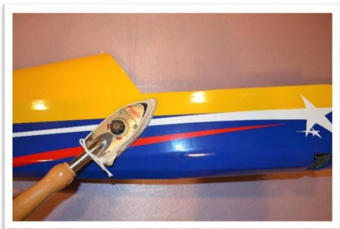
À 200-220°F (93-104°C), l'adhésif sur UltraCote® devient actif permettant au revêtement d'être fixé au modèle. Bien que 220° adhère complètement au revêtement au modèle, il est bien en dessous de la température qui provoque le rétrécissement d'UltraCote®.
