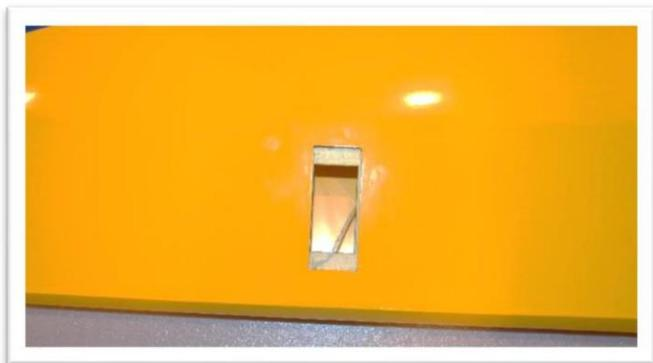
Retirez délicatement la chaîne d'installation du fil de servo et fixez-la temporairement à l'écart. Ne le retirez pas de l'aile. (S'il reste de la colle, grattez-la pour que la surface de montage en bois soit plate.)
