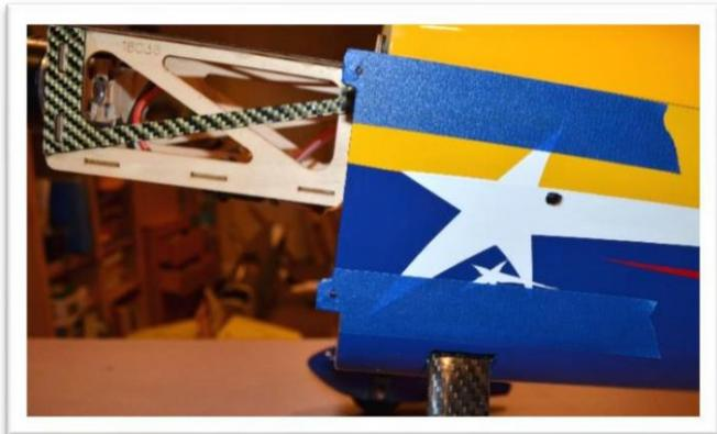
Retirez le ruban adhésif pour pouvoir faire glisser le capot. Centrez-le à l'aide de la plaque d'appui rotative. Laissez un .06-.09" (1.5-2 mm) derrière la plaque arrière. Lorsque vous avez trouvé la position du capot que vous aimez, collez-la solidement en position.
