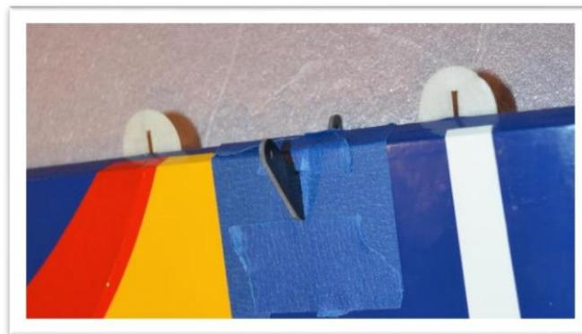
Utilisez de l'époxy pendant 30 minutes pour coller les cornes de commande en place. Centrez le klaxon de commande, retirez le ruban de masquage et nettoyez avec de l'alcool.
