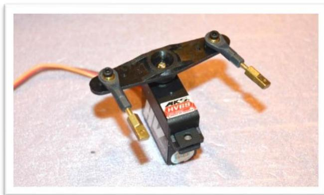
Installez le servo de direction dans le fuselage et pré-percez les vis de montage du servo à l'aide d'une perceuse de 1/16". Installez le servo avec l'arbre cannelé vers l'avant de l'avion à l'aide des vis à bois fournies avec vos servos. Retirez les vis et le servo. Appliquez une goutte de colle CA fine dans chaque trou de vis de montage. Cela durcira le bois autour des vis et fournira une installation plus sûre. (Laissez la colle CA sécher avant de réinstaller le servo.)
