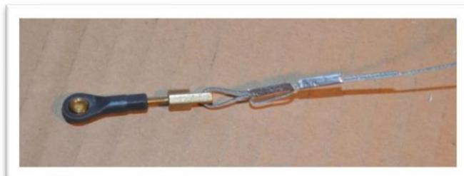
Assemblez 2 rotules et œillets de câble au guignol de commande du gouvernail à l'aide de vis de 2 mm, d'une rondelle et d'un contre-écrou.
