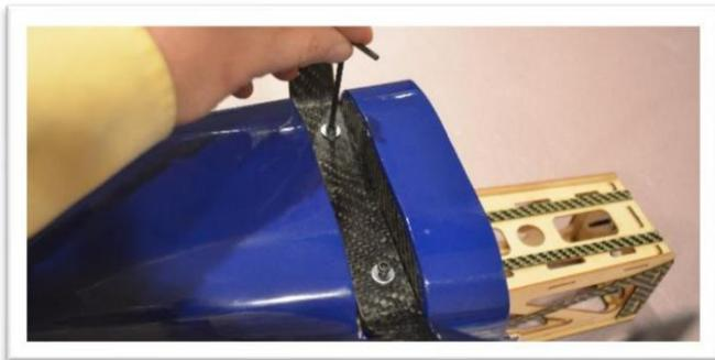
Le bloc de remplissage peut être maintenu en position avec des bandes de matériau de revêtement, du ruban d'emballage, ou il peut être maintenu en position avec un matériau à boucles et crochets comme décrit ci-dessous.
