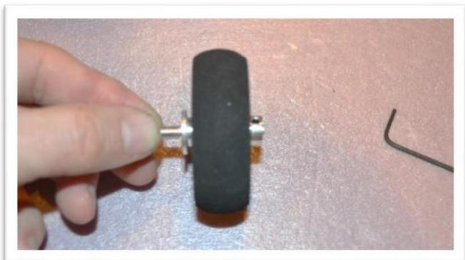
Insérez la roue et l'essieu dans le support de roue, puis dans le train d'atterrissage. Alignez l'indentation du pantalon de roue avec le train d'atterrissage. Ajoutez un contre-écrou en nylon et serrez.
