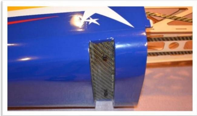
Installez le train d'atterrissage en fibre de carbone à l'aide de 2 rondelles du sac de pièces et des vis à tête creuse. Appliquez une goutte de frein-filet lorsque vous installez ces vis.
