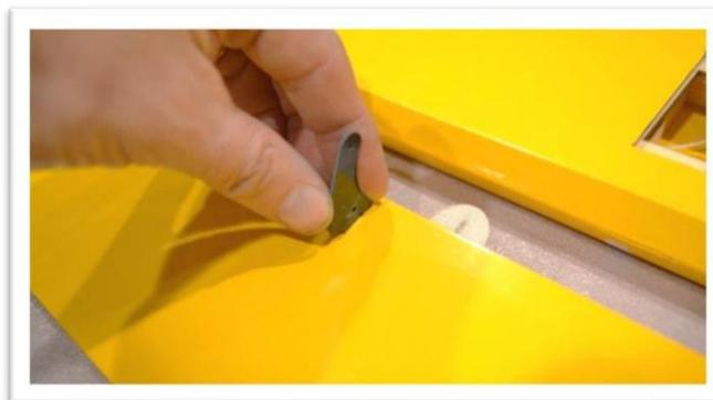
Le klaxon de commande doit aller jusqu'au bout jusqu'à ce que l'épaule touche l'aileron. Le trou de liaison dans le guignol de commande doit être aligné avec l'axe central de la charnière.
