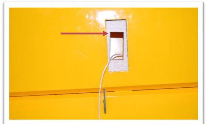
Attachez le fil du servo à la chaîne d'installation et tirez doucement le fil à travers l'aile pendant que vous insérez le servo dans l'aile.
