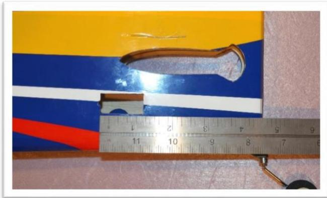
La poche du servo sur le côté droit du fuselage est utilisée pour le servo du gouvernail si vous décidez d'utiliser une configuration push-pull. Ne coupez pas cette poche si vous prévoyez d'utiliser le câble pull-pull pour le gouvernail.
