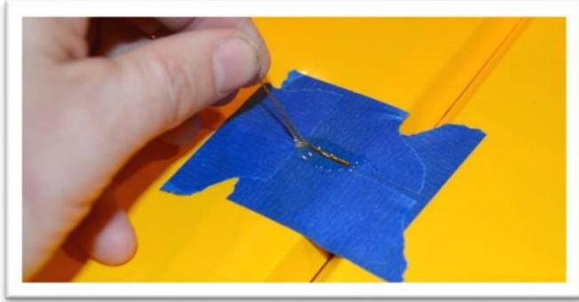
Appliquez de l'époxy sur le klaxon de commande et insérez-le dans la fente. Essuyez l'excédent d'époxy à l'aide d'une serviette en papier et alcool dénaturé.
