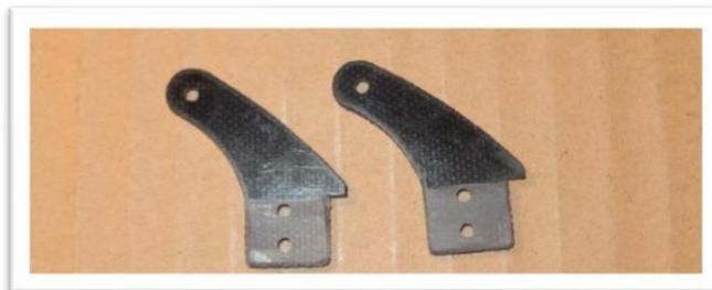
Testez l'ajustement du klaxon de commande dans la fente. Coupez ou limez la fente comme nécessaire pour obtenir un ajustement parfait. (Faites attention à ne pas percer de l'autre côté de l'aileron.)
