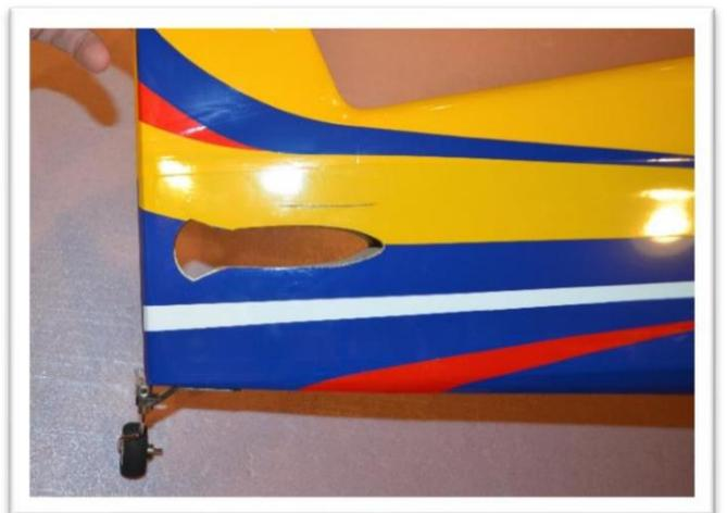
La poche du servo de profondeur se trouve sur le côté gauche de l'avion, à environ 4 1/2" de l'extrémité du fuselage. Utilisez un fer à repasser pour sceller le revêtement sur les bords de la poche avant de la couper.
