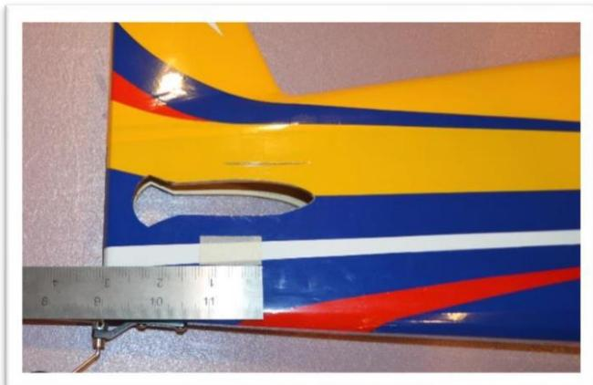
Faites glisser le stabilisateur horizontal à travers le fuselage en le poussant complètement vers l'avant. Centrez-le d'un côté à l'autre à l'aide d'une règle ou d'un ruban à mesurer.
