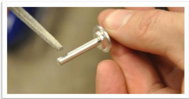
Installez une roue sur l'essieu avec un collier de roue. Positionnez la vis de serrage du collier sur le plat que vous avez déposé.
