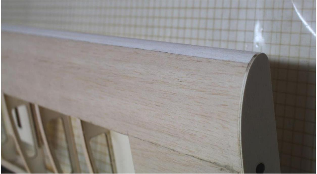
Après séchage, raboter et meuler le bord d'attaque (K2) selon le profil de la nervure supérieure et inférieure
