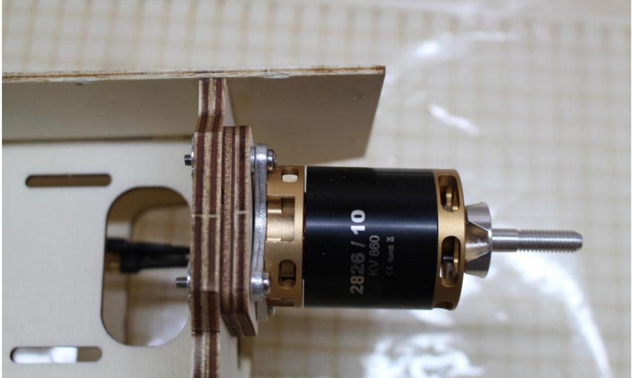
Visser le moteur aux entretoises avec 4x vis M3x20. Les câbles de raccordement moteur pointent vers le bas. Pour régler la traction latérale, placez 2x rondelles entre l'étoile de montage et les entretoises (A8) sous les deux vis droites (vues de face).
