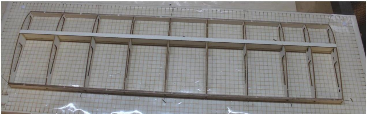
Collez le bord d'attaque auxiliaire (K1), le longeron principal supérieur (I4) et le bord de fuite (L2).
