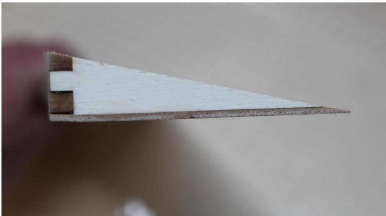
Poncez la bande avant (L1) et le bord arrière du bordé inférieur en biais selon le tracé du profil
