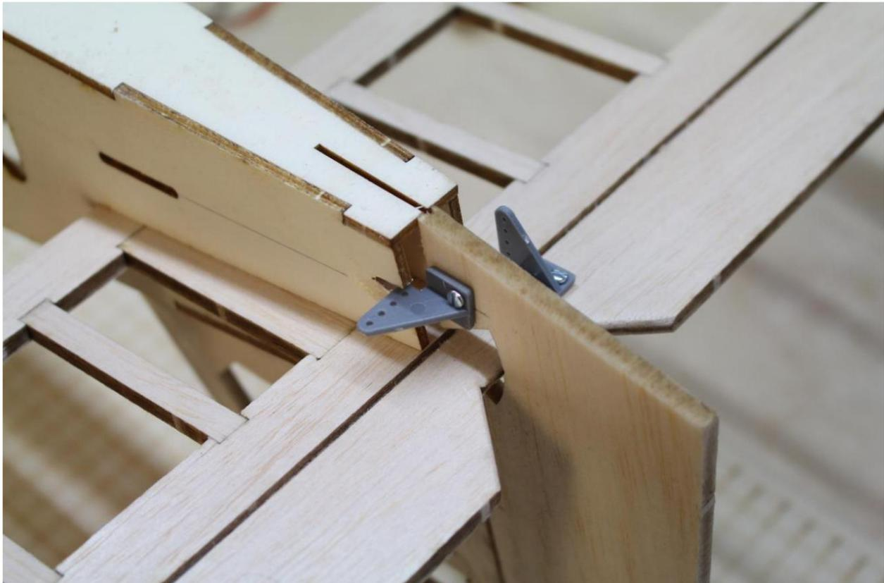
Visser les guignols sur la gouverne de direction et la gouverne de profondeur avec contre-plaque et 2x vis autotaraudeuses Ø2,2x12 mm
