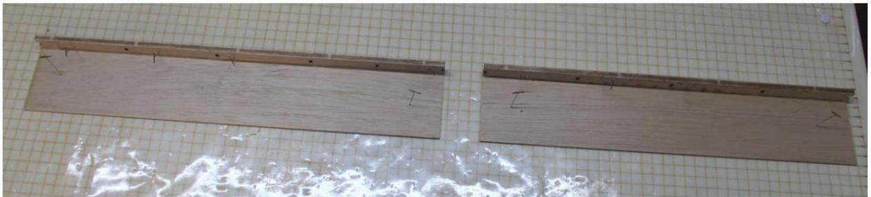
Coupez les peaux inférieures des ailerons (357×70 mm) et des volets (395×70 mm).
