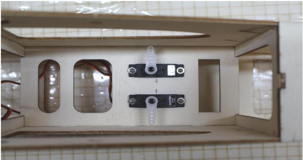
Installez les servos de direction et de profondeur dans le fuselage
