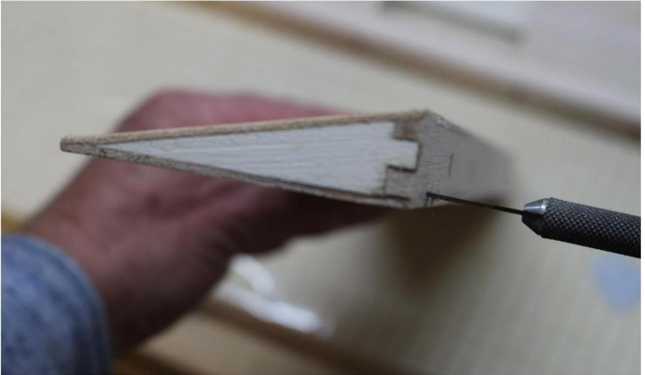
Installez des fentes de charnière dans les ailerons, les volets et l'aile juste sous la peau
