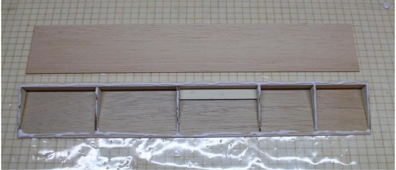
Couper les parties de bordé supérieures (balsa 1,5 mm) pour les ailerons (360×75 mm) et les volets d'atterrissage (400×75 mm) Poser les parties de bordé à plat sur le panneau de construction Appliquer de la colle sur le dessus des ailerons et des volets d'atterrissage
