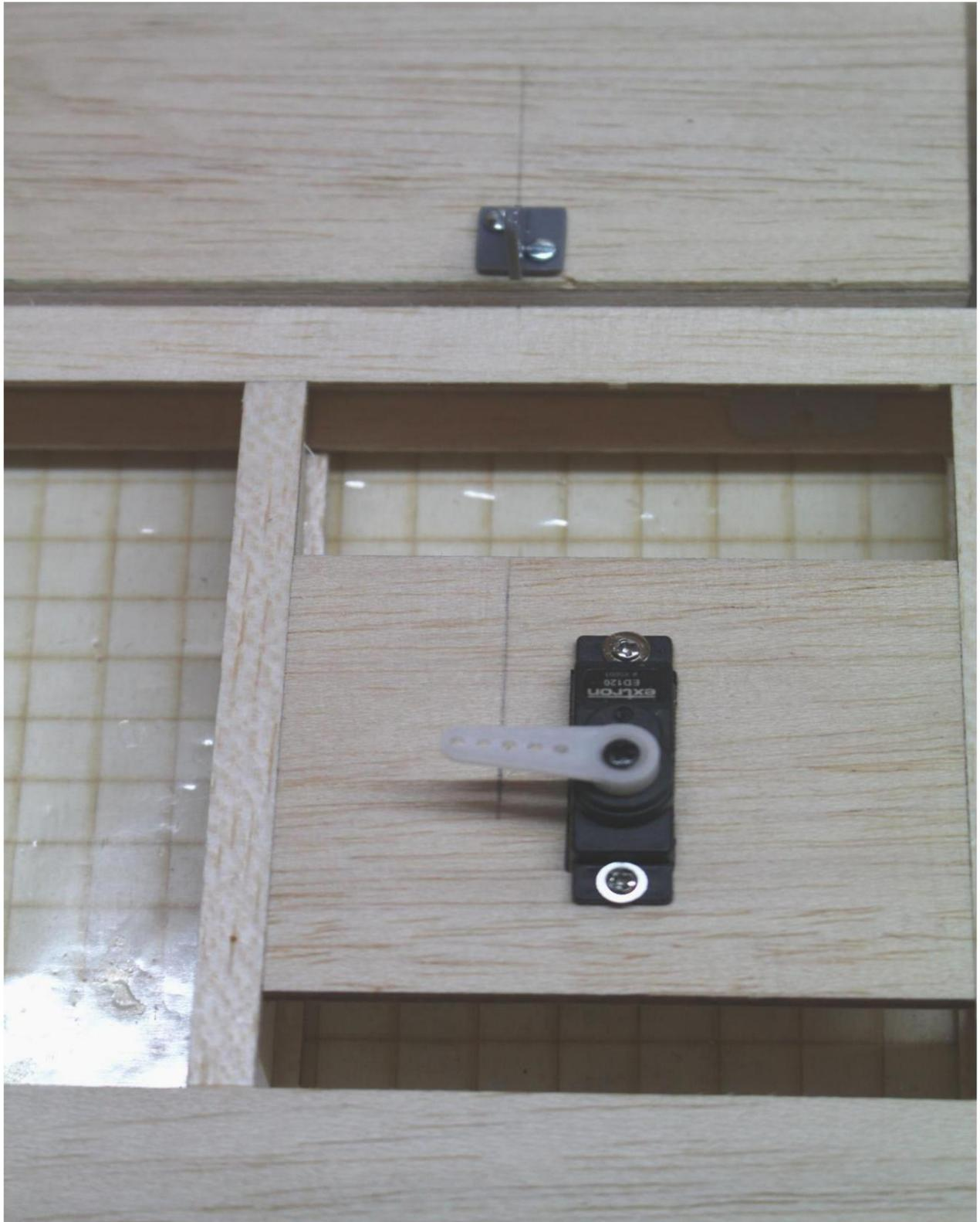
Déterminer l'emplacement des guignols de commande
