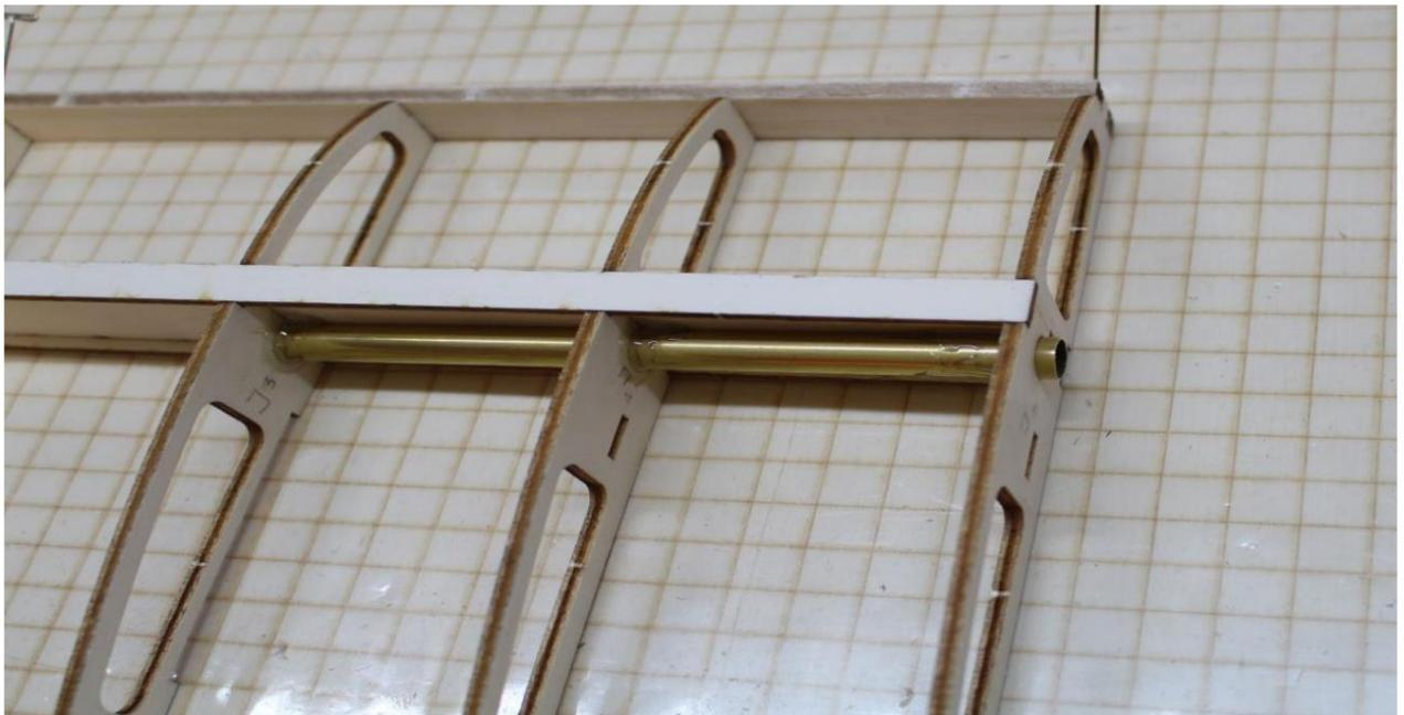
Coller le tube guide du connecteur d'aile (laiton, Ø9×135 mm) dans les nervures (J5 – J3) avec de l'époxy 5 min
