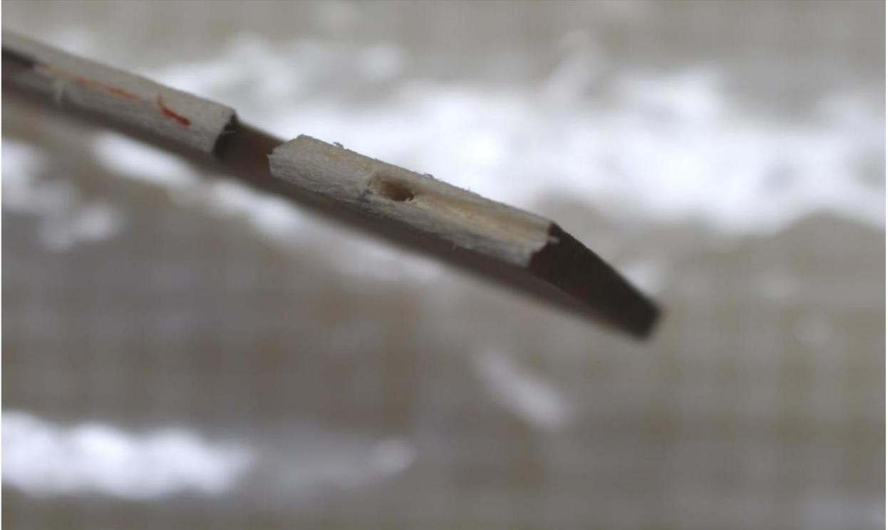
Percez un trou de 2 mm (angle droit) et une rainure de 2 mm de large dans le bas du gouvernail.
