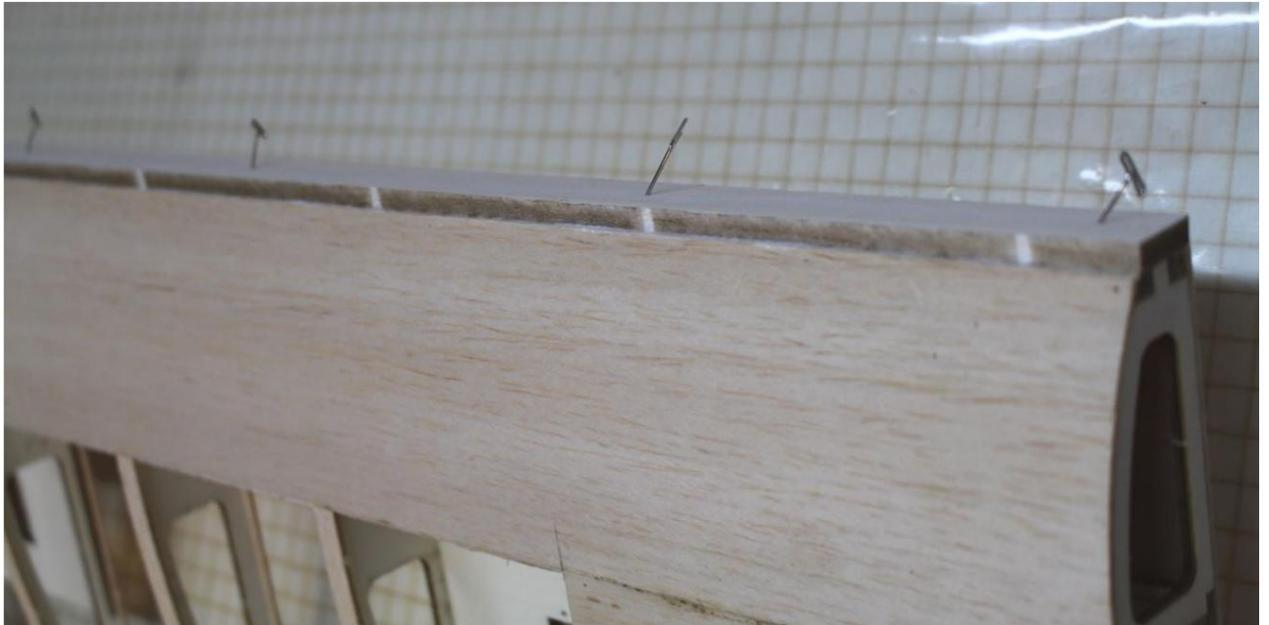
Meuler le bord d'attaque auxiliaire (K1) et le bord d'attaque à plat
