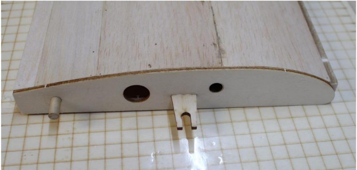
Coller le boulon de torsion (hêtre Ø6×30 mm) et le support pour la connexion à vis à ailettes (A2) dans la racine ou la nervure du couvercle (I3).
