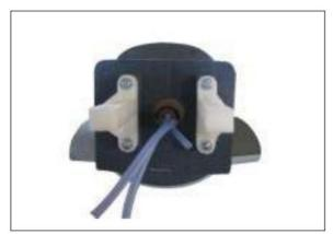
9) Connectez les conduites du réservoir au moteur et au silencieux. La conduite de ventilation se connectera au silencieux et la conduite du clnk au carburateur.
