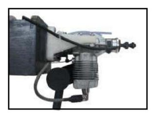
8) Réinstallez le palonnier du servo en faisant glisser le connecteur sur le fil de la tige de poussée. Centrez le manche des gaz, réglez et installez le palonnier du servo perpendiculairement à la ligne centrale du servo.
