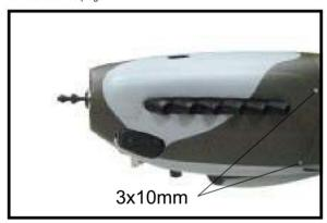
3 3) Installer le silencieux et l'extension du silencieux sur le moteur et faites la découpe dans le capot pour le dégagement du silencieux. Brancher le carburant et conduites de pression vers le carburateur, le silencieux et le robinet de remplissage de carburant. Fixez le capot au fusible à l'aide des vis 3x10 mm pour serrer le des vis.
