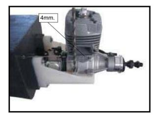
3) Utilisez une perceuse pour percer les quatre trous dans les rails de support moteur.
