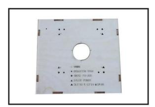
Utilisez un foret 1/4 pour percer les trous de montage du moteur. Retirez le gabarit de montage du mur, par exemple. Pare-feu illustré avec trous de montage percés, prêts pour le montage du moteur.
