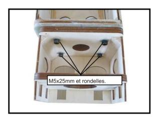
4) Fixez le moteur à l'avant du boîtier du moteur électrique à l'aide de quatre écrous borgnes de 4 mm et de quatre boulons à tête hexagonale M4x20 mm pour fixer le moteur. Veuillez voir l'image affichée.
