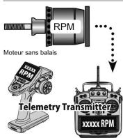
Le RPM d'un moteur brushless peut être visualisé sur votre émetteur sans retirer l'aimant du moteur en utilisant uniquement une connexion de câblage (la soudure est nécessaire).
