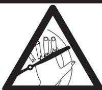
Une hélice endommagée ou dessérée peut se désintégrer ou être éjectée très loin sachant que les bouts de pales peuvent tourner à des vitesses excédant les 180 mètres par seconde sur des moteurs puissants. Il faut bien comprendre que de tels événements peuvent conduire à de très sérieuses blessures. (lire "NOTES", chapitre qui se rapporte à la sécurité des hélices).
