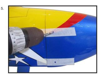
Installer le muler et l'extension muler sur le moteur et faites la découpe dans le capot pour le dégagement du mulet. Connectez les conduites de carburant et de pression au carburateur, au collecteur et à la valve de remplissage de carburant. Fixez le capot Au fuselage à l'aide des vis à tête creuse M3x12mm. Mettre une petite longueur de tube de carburant en silicone sous la tête de la vis aide à réduire les vibrations.
