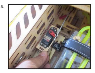
Réinstallez le klaxon du servo en faisant glisser le connecteur sur le fil de la tige de poussée. Centrez le manche des gaz, réglez et installez le palonnier du servo perpendiculairement à la ligne centrale du servo.
