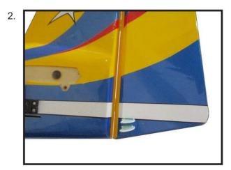
Passez le câble du gouvernail à travers un tube de sertissage en laiton, puis le collier fileté, et revenez à travers le tube de sertissage en laiton des deux côtés. Tirez une légère tension sur
