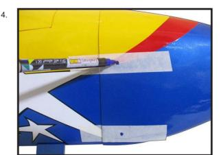
Utilisez une perceuse et un foret pour percer les trous pour les vis de montage du capot. Assurez-vous que la position du capot est correcte avant de percer chaque trou.
