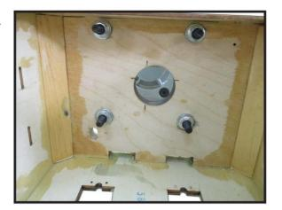
le mur de feu a l'emplacement pour le tube de tige de poussée d'accélérateur (pré-perçage).
