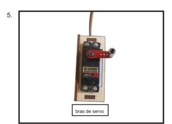
Installez le servo d'accélérateur dans le plateau de montage du servo.
