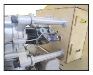
Fixez la tige de poussée de l'accélérateur au carburateur. tor papillon des gaz avec la rotule.
