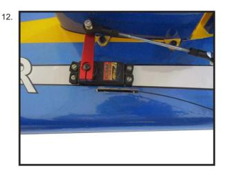
passer le câble à travers le tube à sertir en laiton.
