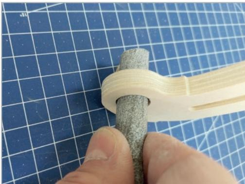
**WICHTIGER HINWEIS:** Bauteil # 7 (Holzringe) sind bewusst untermaßig hergestellt um mögliches Spiel durch Fertigungstoleranzen ausgleichen zu können. Diese Ringe müssen vor Montage geg. mit Schleifpapier vorsichtig etwas aufgeschliffen werden, sodass diese leicht aber spielfrei auf den Aluohren gleiten können!
