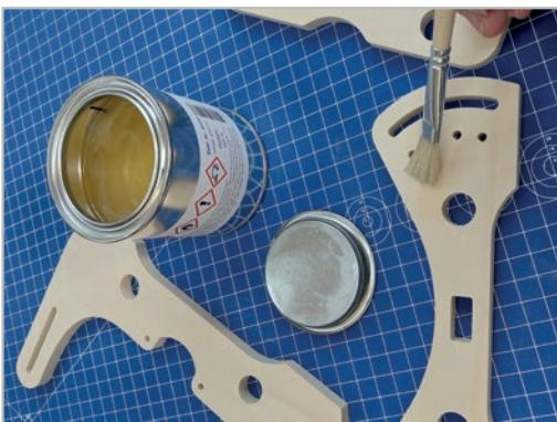
Wir empfehlen sämtliche Holzteile mit Schnellschliffgrund (Porenfüller) vor Montage zu behandeln. Dadurch bleibt ihr „Ro-Spider“ länger schön, und es entstehen durch den Gebrauch keine Verbeschmutzungen an den Teilen.
