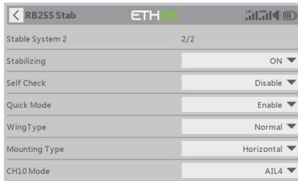
Remarque : Les paramètres des systèmes stables 1 et 2 sont indépendants et doivent tous deux être calibrés lors de la mise en route. Un calibrage d'auto-vérification est requis.
