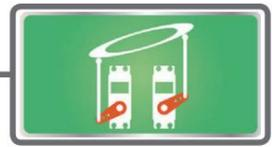
La fonction swash mix est utilisée pour corriger le plateau cyclique dans le sens des ailerons (roulis) et de la profondeur (pas cyclique) correspondant à chaque opération de chaque condition.
