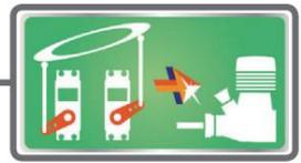
Cette fonction corrige le ralentissement du régime moteur provoqué par le fonctionnement du plateau cyclique pendant le fonctionnement des ailerons ou de la profondeur. La méthode d'application dans le sens des aiguilles d'une montre
