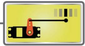
La fonction Sub-Trim est utilisée pour régler la position neutre du servo et peut être utilisée pour effectuer des réglages précis de la surface de contrôle une fois les tringleries et les tiges de poussée branchées. Lorsque vous commencez à configurer un modèle, assurez-vous que les trims numériques sont réglés sur leur position centrale.
