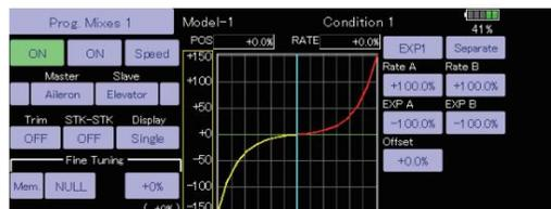
Cette section décrit la procédure de réglage des courbes utilisées avec la fonction AFR et chaque fonction de mixage.
