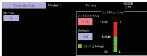
\*Avec le manche des gaz au ralenti, ajustez la position de coupe jusqu'à ce que le moteur s'arrête systématiquement, mais que la tringlerie des gaz ne soit pas contraignante. Une fois terminé, appuyez sur le bouton « Throttle Cut » pour quitter.
