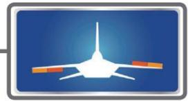
en mode aileron. Lorsque le manche d'aileron est manipulé, les ailerons et les volets de carrossage se déplacent simultanément et l'axe de roulis est amélioré.
