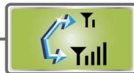
Le « mode de contrôle de portée » réduit la portée de transmission des ondes radio pour permettre une vérification de la portée au sol.
