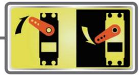
Servo Reverse change la direction de la réponse d'un servo individuel à un mouvement du manche de commande.
