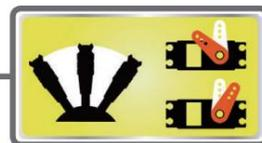
Le mixage programmable peut être utilisé pour corriger des tendances indésirables de l'avion, et il peut également être utilisé pour des configurations de contrôle inhabituelles. Le mixage signifie que le mouvement d'un canal de commande, appelé « maître », est ajouté au mouvement du canal mixte, appelé « esclave ».
