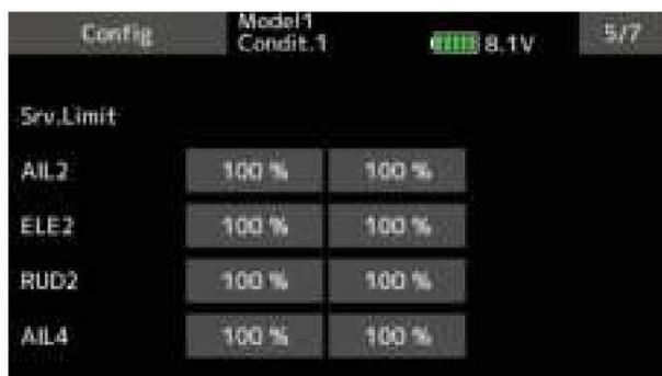
Si la sortie du port SB/R2 est réglée sur « S.BUS(HS) » ou « S.BUS(STD) », le menu de réglage affichera les éléments de réglage AIL3 et AIL4.
