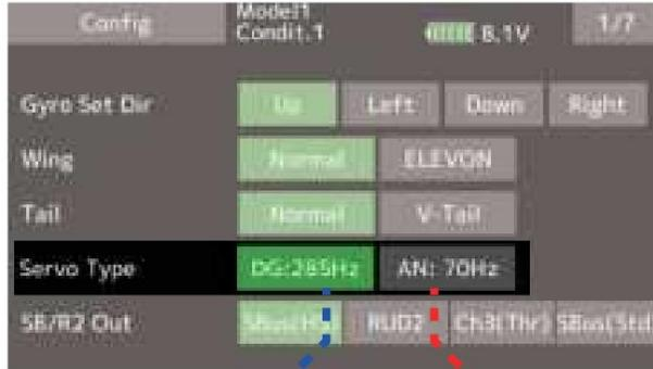
Sélectionnez le type de servo en fonction du servo à utiliser.
