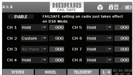
3. La sécurité intégrée peut être réglée sur le récepteur en appuyant brièvement sur le bouton F/S tout en déplaçant la position du canal vers une valeur prédéfinie après la liaison.
