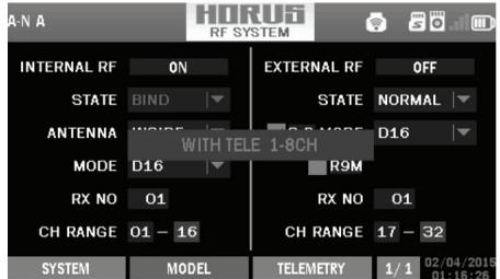
1.3 Pour le module émetteur RF (XJT par exemple), allumez la radio tout en maintenant enfoncé le bouton FS du module, relâchez le bouton et la LED ROUGE du module XJT clignote.
