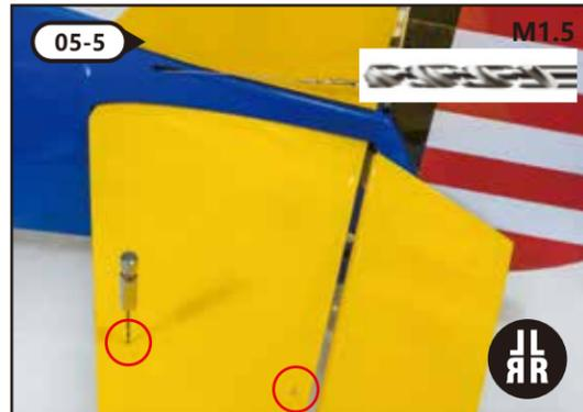
Wie oben gezeigt zwei Löcher an den Markierungen des Seitenleitwerks bohren und etwas Sekundenkleber anbringen.
