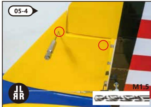
Wie oben gezeigt zwei Löcher an den Markierungen des Höhenleitwerks bohren und etwas Sekundenkleber anbringen.
