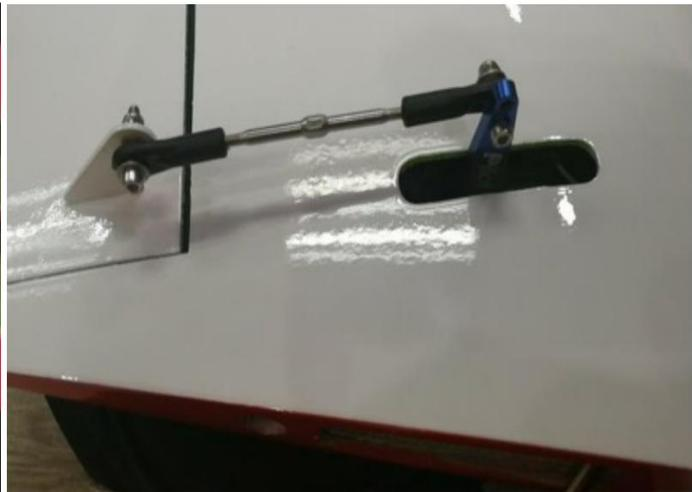
3: L'autre côté du connecteur servo colle sur le côté du fuselage, juste une goutte de CA ou 5 min d'époxy pour le coller.
