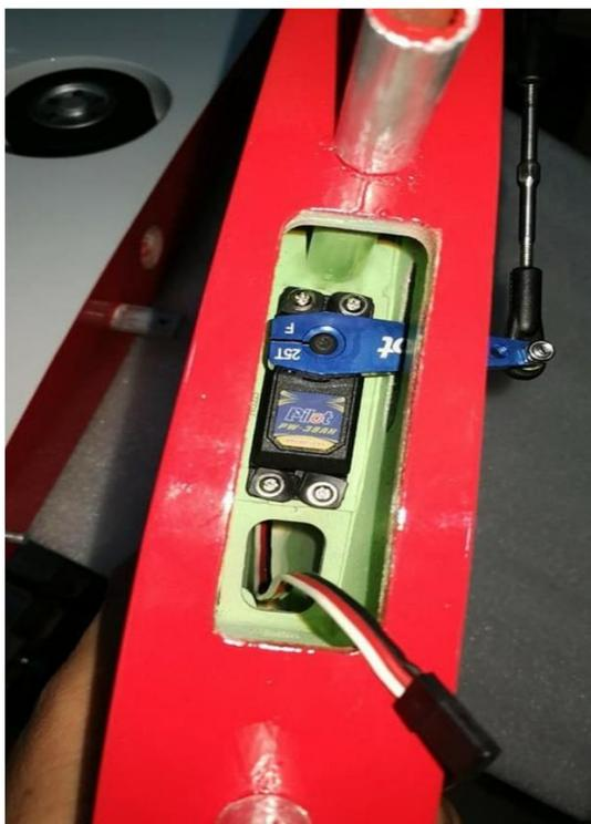
3. Vissez le servo en place, puis installez le bras de servo sur le servo, en veillant à ce qu'il soit centré. Fixez les poussoirs inclus et liaisons à billes entre le bras de servo et le klaxon de commande.
