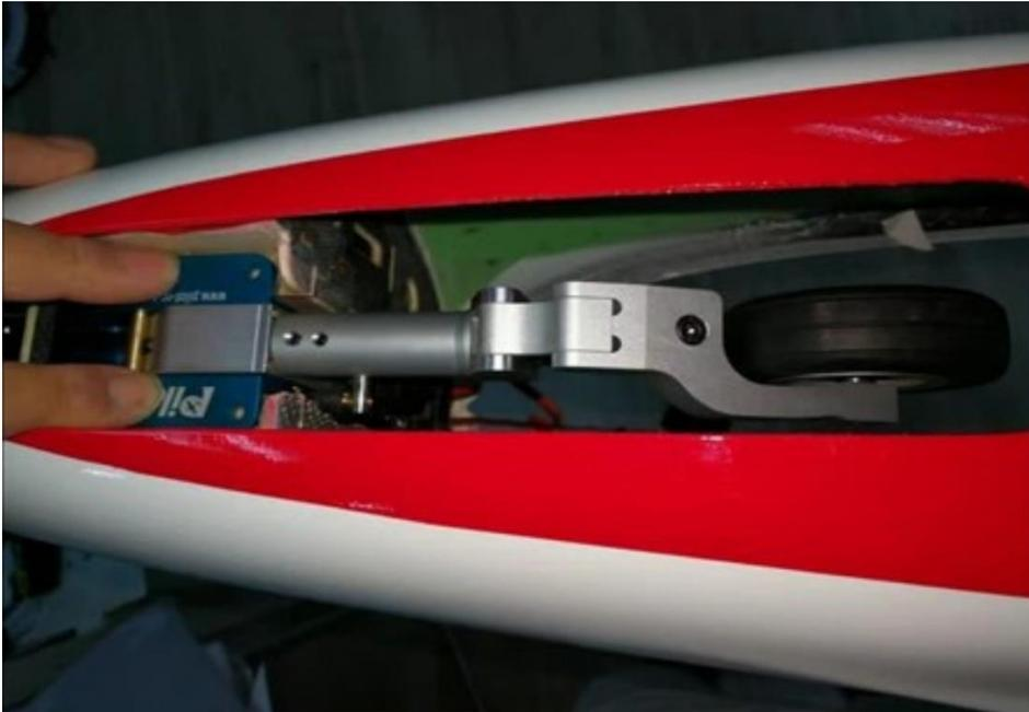
Avant de percer le trou des vis de montage, assurez-vous qu'il n'y a rien à coincer lors de l'ouverture et de la fermeture.
