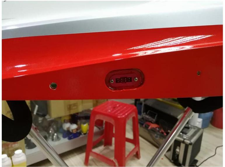
7. Juste un connecteur pour aileron/volets/train d'atterrissage/freins.
