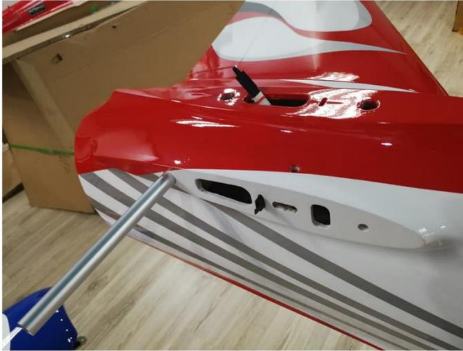
2. Trouvez les 2 vis d'assemblage M4 pour le serrer. Il maintiendra la position du gouvernail
