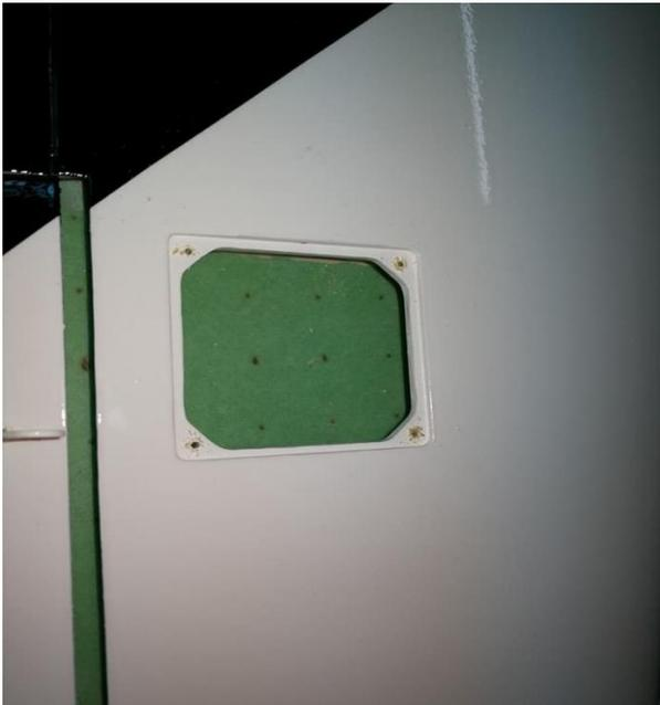
Avec les ailes à l'envers, placez l'engrenage à l'intérieur de l'aile sur les supports de montage et marquez l'emplacement des vis.
