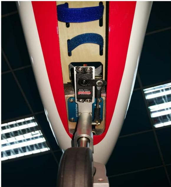
Disposez soigneusement le câble de rétraction du train avant ainsi que le câble de direction ...
