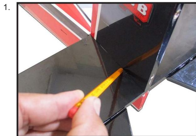
Tout en maintenant fermement le stabilisateur vertical en place, utilisez un stylo et tracez une ligne de chaque côté du stabilisateur vertical à l'endroit où il rencontre le haut du fuselage.
