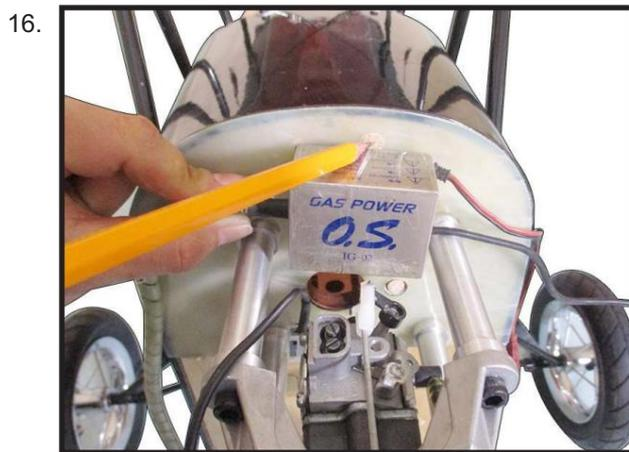
Connectez le module d'allumage à la ligne de collecte du moteur. Fixez avec un clip de sécurité, un fil de sécurité, du ruban adhésif ou une autre méthode. Assurez-vous que les fiches ne se détacheront pas à cause des vibrations ou d'une légère tension.
