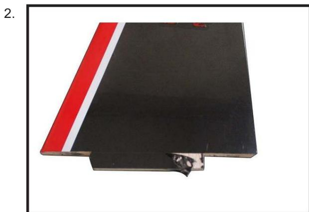
À l'aide d'un couteau à modeler, retirez le revêtement situé au-dessus de la fente de charnière prédécoupée découpée dans la partie inférieure arrière du fu-selage.
