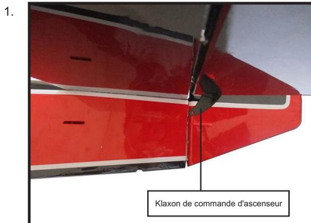
Vissez une chape et un contre-écrou M3 sur chaque tige de commande d'ascenseur. Enfillez les cornes jusqu'à ce qu'elles soient en contact avec les extrémités des barres de commande.
