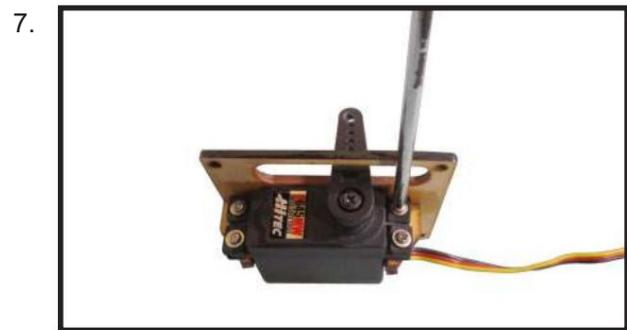
Appliquez 1 à 2 gouttes de C/A fin sur chacune des languettes de montage. Laissez le C/A durcir sans utiliser d'accélérateur.
