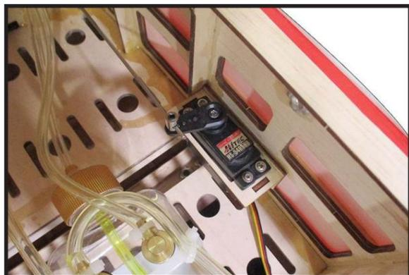
Réinstallez le klaxon du servo en faisant glisser le connecteur sur le fil de la tige de poussée. Centrez le manche des gaz, réglez et installez le palonnier du servo perpendiculairement à la ligne centrale du servo.
