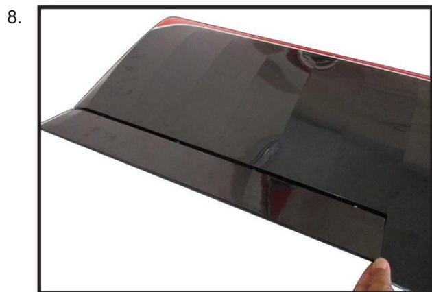
Vérifiez l'état de l'aileron sur l'aile. Le haut des ailerons s'alignera sur le haut de l'aile. Assurez-vous que le mouvement est fluide et sans attache.
