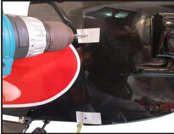
Installez le muler et l'extension du muler sur le moteur et faites la découpe dans le capot pour le dégagement du muler. Connectez les conduites de carburant et de pression au carburateur, au collecteur et à la valve de remplissage de carburant. Fixez le capot au fuselage à l'aide des vis à tête creuse M3x10 mm. Placer une petite longueur de tube de carburant en silicone sous la tête de la vis aide à réduire les vibrations.
