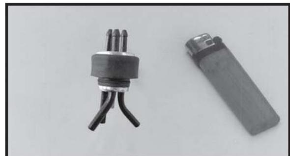
34) Chauffez soigneusement le tube d'aération à l'aide d'un pistolet thermique ou d'un briquet pour régler définitivement l'angle du tube.
