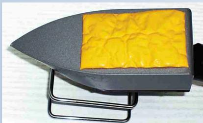
Fig. 3C Test de température du fer à 150 °C
