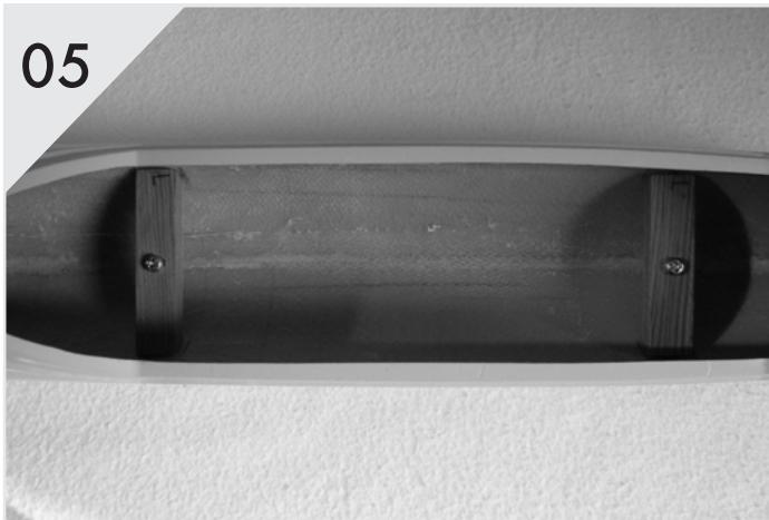
Le plancher support de l'accu peut être collé en place dans le fuselage. Mais avec un peu d'initiative personnelle, il peut très bien être rendu démontable grâce à une fixation par vis comme montré ici. Pour cela il faut fabriquer 2 supports en baguettes de pin.
