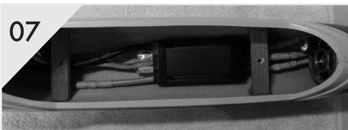
Anschließend mit Pattex Stabilit oder Endfest einkleben. Der Vorteil dieser Bauweise ist auf diesem Bild ersichtlich. Der Regler kann unter dem Brett verlegt werden.
