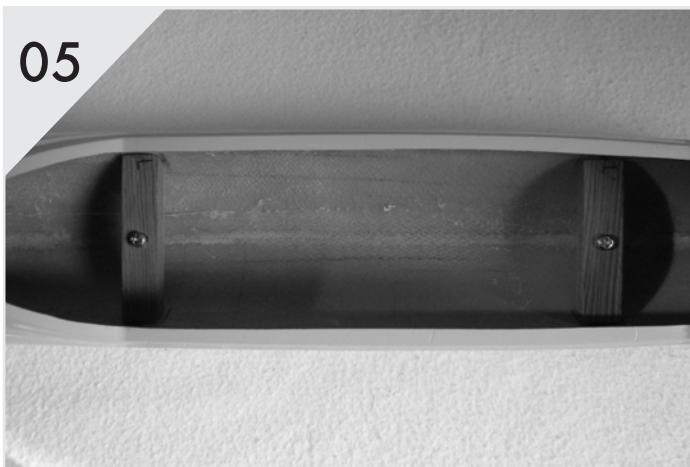
Das Akkubrett kann fest in den Rumpf eingeklebt werden. Es kann aber auch mit etwas Eigeninitiative, wie hier gezeigt, heraus schraubar gebaut werden. Hierzu 2 Stege aus Kieferleisten anfertigen. Diese bilden die Basis für das Akkubrett.
