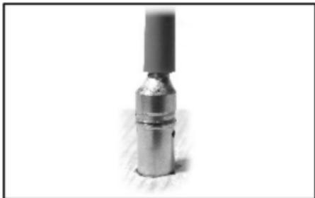
6) Les connecteurs soudés doivent être isolés avec une gaine thermorétractable.
