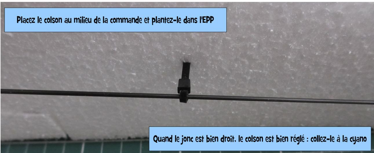
Plantez le colson dans l'EPP au milieu de la commande. Réglez-le pour que la commande soit bien droite. Quand c'est fait on colle le colson avec une **goutte de cyano épaisse**.
