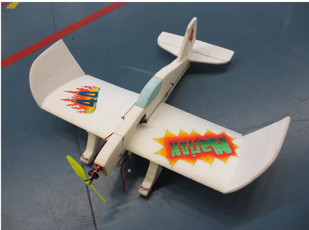
Reste à installer le variateur, le récepteur et le velcro pour tenir le lipo de propulsion.
