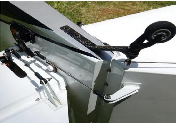
27. Si vous prévoyez de garder vos stabs attachés au fuselage pendant le transport, une rallonge de servo de 36" 20 Awg est assez longue. Si vous prévoyez de retirer les stabs, vous devrez utiliser une rallonge de 48". Fixez l'extension au câble du servo de profondeur avec un clip de sécurité EF Servo ou une gaine thermorétractable.
