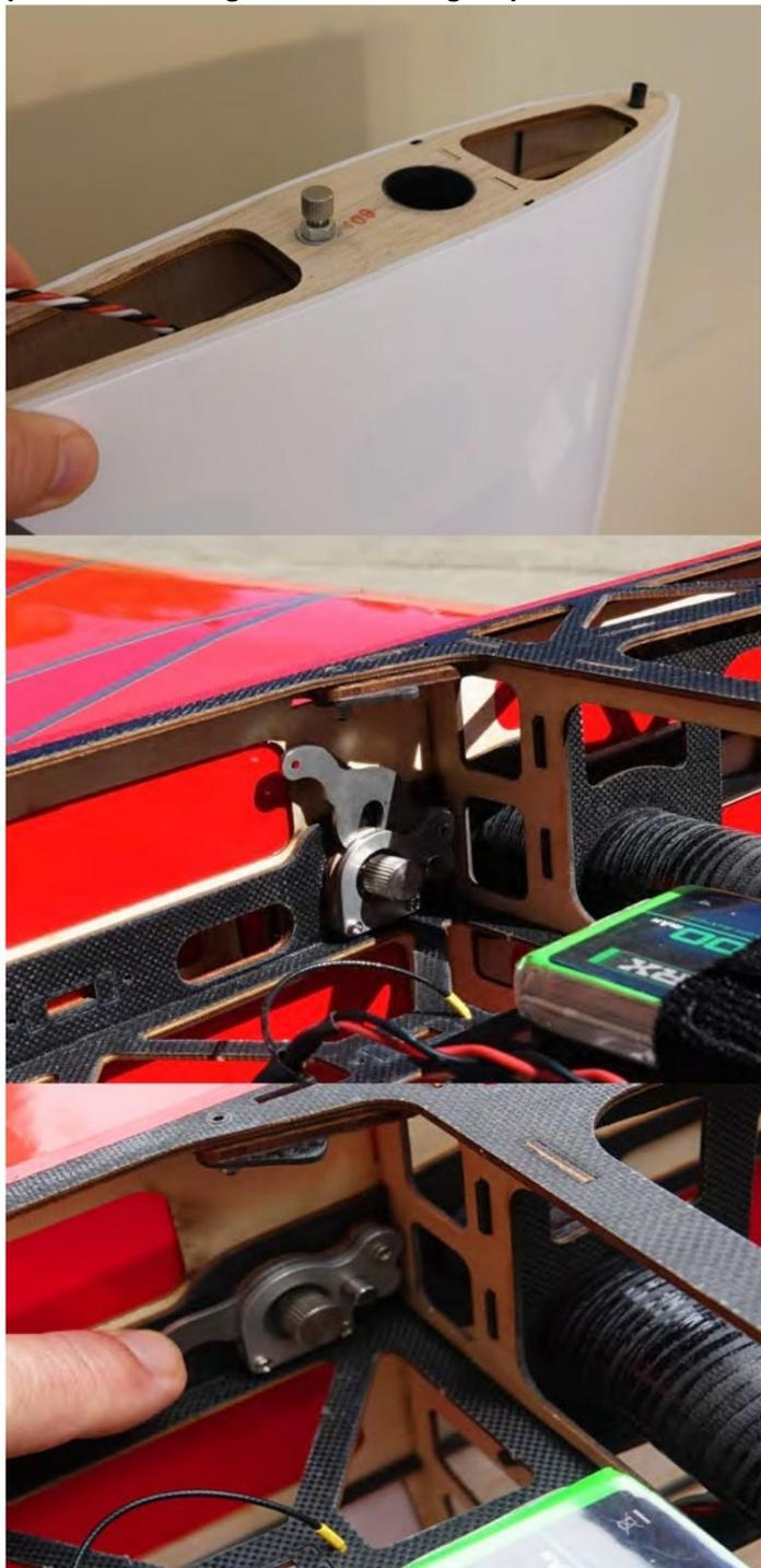
36. Votre MXS comprend un ensemble de générateurs de force latérale (SFG) ainsi que 2 entretoises transparentes à installer entre les SFG et l'extrémité de l'aile pour les empêcher d'interférer avec le mouvement des ailerons. Ils doivent être installés à l'aide des vis à oreilles blanches fournies, vissées dans les trous du SFG, à travers l'entretoise transparente et dans les écrous aveugles préinstallés dans le bout de l'aile.
