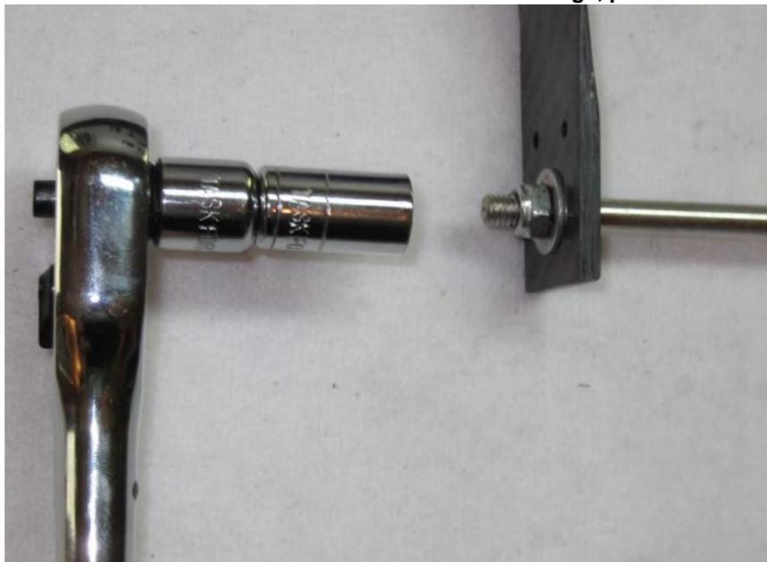
**15. Utilisez votre outil rotatif et une meule ou une lime pour créer un point plat sur l'essieu pour que le collier de roue et les vis de réglage du support de pantalon de roue puissent s'asseoir contre. Fixez le support d'essieu en aluminium à l'entretoise en contreplaqué avec les vis à bois fournies.**
