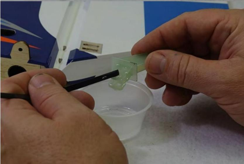
7. Insérez les guignols de commande dans les fentes et assurez-vous que les guignols sont correctement calés contre la plaque de base et que la plaque de base est à plat contre la surface de commande.
