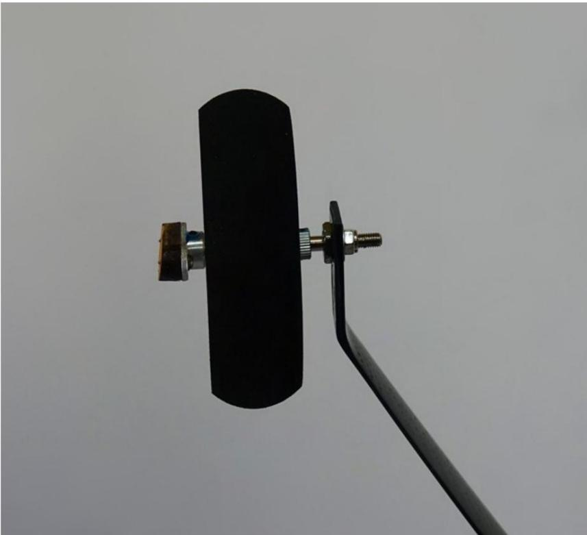
17. Faites glisser le pantalon de roue en position et fixez-le avec 2 boulons et rondelles de 3 mm insérés dans l'engrenage en carbone et dans les écrous borgnes du pantalon de roue. Assurez-vous d'utiliser du frein-filet sur les boulons! Retirez le pantalon du bloc de support en contreplaqué et posez un cordon d'époxy sur la surface du contreplaqué pour faire adhérer le bloc à la paroi du pantalon de roue. Cela ajoute une énorme quantité de force et de rig
