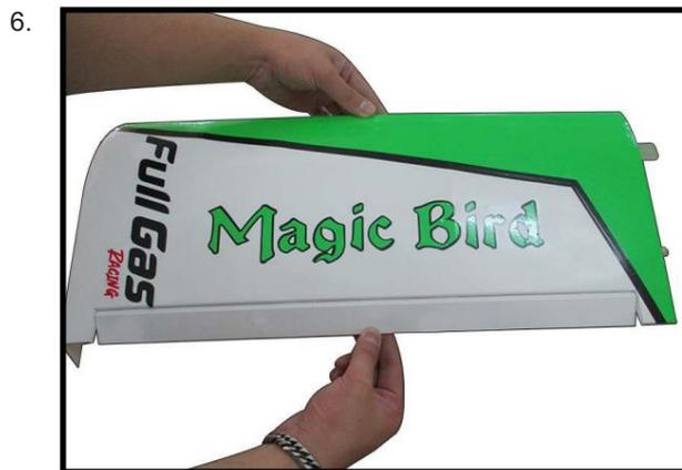
Retournez le panneau d'aile et dévissez l'aileron dans la direction opposée au côté opposé. Appliquez une fine colle C/A sur chaque charnière, en vous assurant que le C/A pénètre à la fois dans l'aileron et le panneau d'aile.
