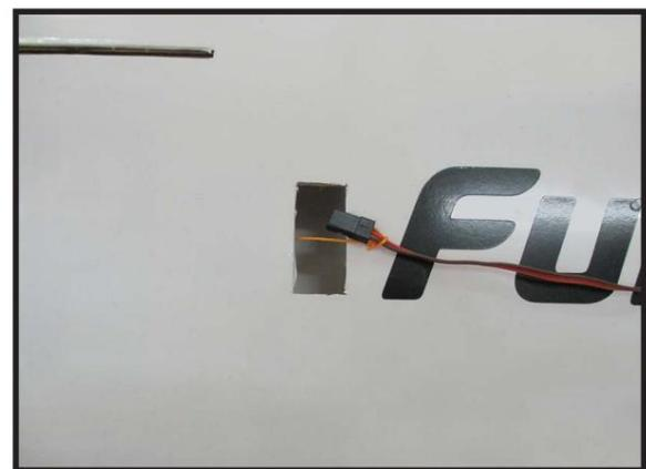
Fixez le fil du servo au servo d'aileron.
