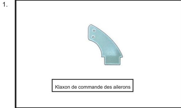
Utilisez du papier de verre pour gratter le bas des ailerons et les guignols de commande de tour. Utilisez une serviette en papier et de l'alcool isopropylique pour éliminer les huiles ou les débris des klaxons de commande.
