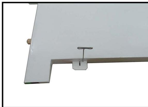
Faites glisser le panneau d'aile sur l'aileron jusqu'à ce qu'il n'y ait qu'un léger espace. La charnière est désormais centrée sur le panneau d'aile et l'aileron.
