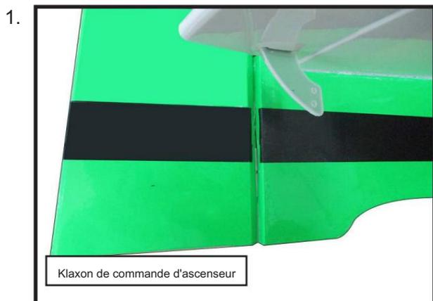
Vissez une chape et un contre-écrou M2 sur chaque tige de commande d'ascenseur. Enfilez les cornes jusqu'à ce qu'elles soient en contact avec les extrémités des barres de commande.
