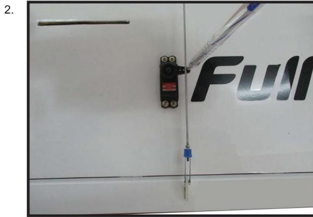
Connectez la tringlerie comme indiqué et fixez le fil de commande avec un dispositif de retenue.
