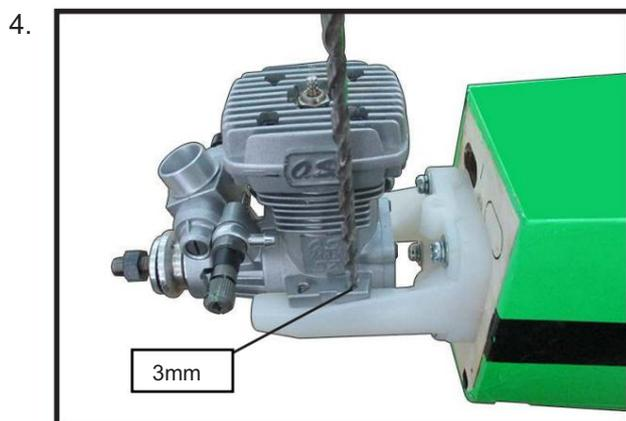
Utilisez une perceuse pour percer les quatre trous dans les rails de support moteur.
