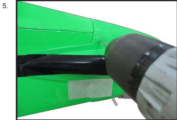
Installez le Muler et l'extension Muler sur le moteur et faites la découpe dans le capot pour le dégagement du Muler. Connectez les conduites de carburant et de pression au carburateur, au collecteur et à la valve de remplissage de carburant. Fixez le capot au fuselage à l'aide des vis à tête creuse M3x10 mm. Placer une petite longueur de tube de carburant en silicone sous la tête de la vis aide à réduire les vibrations.
