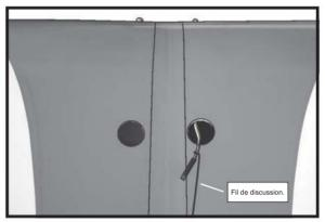
3 4) Attachez le câble du servo à l'aile pour éviter qu'il ne retombe dans l'aile.
