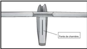
3 2) Faites glisser le stabilisateur vertical dans la fente située en haut du fuselage. Le bord arrière du stabilisateur doit affleurer le bord arrière du fuselage et la charnière inférieure du gouvernail doit s'engager dans la fente de charnière prédécoupée dans le bas du fuselage. Le bord inférieur du stabilisateur doit également être fermement poussé contre le haut du stabilisateur horizontal.
