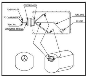
3 4) Chauffez soigneusement le tube de ventilation à l'aide d'un pistolet thermique ou d'un briquet pour régler de manière permanente l'angle du tube.
