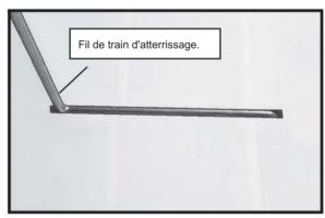
$3\ 3$ ) Le fil du train d'atterrissage est maintenu en place à l'aide de deux sangles en nylon du train d'atterrissage et de quatre vis à bois de  $3\ \text{mm}\ \text{x}\ 10\ \text{mm}$ .
