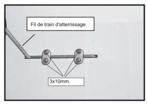
$3\,6$ ) Réinstallez le fil d'engrenage et installez les sangles à l'aide des quatre vis à bois  $3\,x\,10$  mm.
