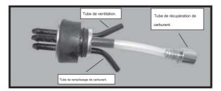
Lorsque le bouchon est installé dans le réservoir, le haut du tube de ventilation doit reposer juste en dessous de la surface supérieure du réservoir. Il ne doit pas toucher le haut du réservoir.
