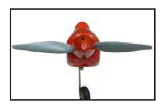
L'hélice ne doit toucher aucune partie du cône tournant. Si c'est le cas, utilisez un couteau à modeler bien aiguisé et coupez soigneusement le cône rotatif à l'endroit où l'hélice entre en contact avec lui.
