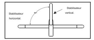
3 6) Lorsque vous êtes sûr que tout est correctement aligné, mélangez une quantité généreuse de 30 Minute Epoxy. Appliquez une fine couche sur la fente de montage située en haut du fuselage ainsi que sur les côtés et le bas de la zone de montage du stabilisateur vertical. Appliquez de l'époxy sur les bords inférieur et supérieur du bloc de remplissage ainsi que sur la charnière inférieure.
