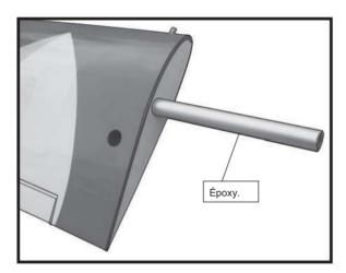
Faites glisser délicatement les deux moitiés d'aile ensemble et appuyez-les fermement l'une contre l'autre, permettant à l'excédent d'époxy de s'écouler. Il ne doit y avoir aucun espace entre les moitiés d'aile. Utilisez de l'alcool à friction et une tour de papier pour nettoyer tout excès d'époxy.
