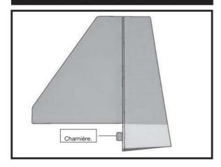
3 1) À l'aide d'un couteau à modeler, retirez le revêtement de la fente de charnière prédécoupée découpée dans la partie inférieure arrière du fuselage. Cette fente accepte la charnière inférieure du gouvernail.
