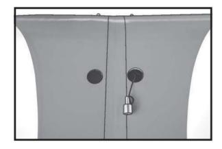
3 3) Fixez le câble du servo au servo d'aileron.
