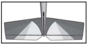
3 8) Une fois l'époxy complètement durci, retirez le ruban de masquage ou les broches en T utilisés pour maintenir le stabilisateur en place. Inspectez soigneusement les joints de colle. Utilisez plus d'époxy pour combler les vides qui pourraient exister et qui n'ont pas été comblés auparavant et nettoyez l'excédent à l'aide d'une serviette en papier et d'alcool à friction.
