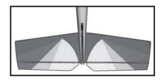
3 4) Une fois le stabilisateur fermement maintenu en place, utilisez un stylo et tracez des lignes sur le stabilisateur à l'endroit où celui-ci et les côtés du fuselage se rejoignent. Faites cela sur les côtés droit et gauche ainsi que sur le haut et le bas du stabilisateur.
