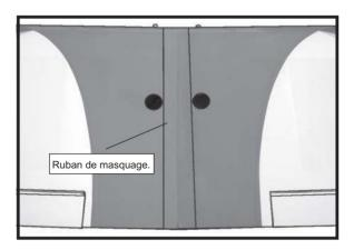
3 3) Décollez le support de la bande de revêtement autocollante. Appliquez la bande sur la partie centrale de l'aile en commençant par le bord de fuite inférieur. Enroulez la bande tout autour de l'aile jusqu'à ce qu'elle rejoigne le bord de fuite.
