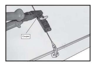
3 8) Faites un coude à 90 degrés au niveau de la marque et coupez l'excédent de fil en laissant 10 mm au-delà du coude.
