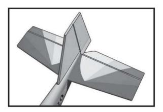
3 3) Tout en maintenant fermement le stabilisateur vertical en place, utilisez un stylo et tracez une ligne de chaque côté du stabilisateur vertical à l'endroit où il rencontre le haut du fuselage.
