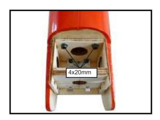
4) Fixez le moteur à l'avant du boîtier du moteur électrique à l'aide de quatre écrous borgnes de 4 mm et de quatre boulons à tête hexagonale M3x15 mm pour fixer le moteur. Veuillez voir l'image affichée.
