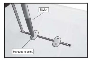
3 5) Retirez les deux sangles et le fil d'engrenage. Percez quatre trous pilotes de 1,5 mm dans l'aile pour les vis à bois.
