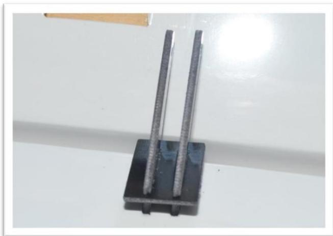
Vérifier l'alignement du klaxon de commande sur la charnière ligne médiane. Le trou de liaison dans le guignol de commande doit être aligné avec l'axe central de la charnière.
