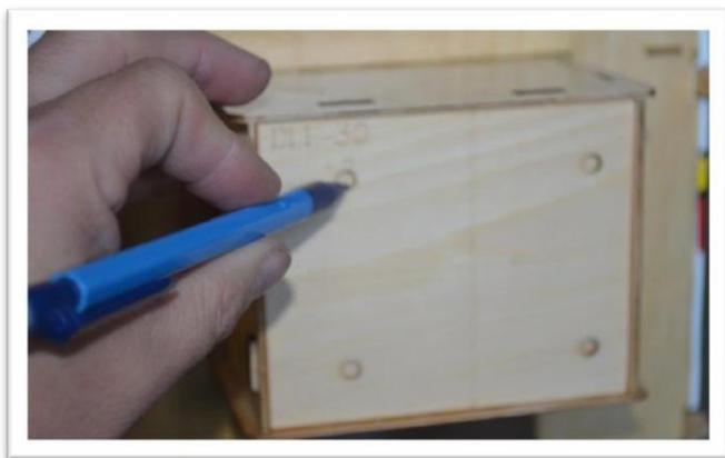
Percez des trous de 3/16" (4,5 mm) à travers le pare-feu. Utilisez ensuite un boulon et une rondelle de 4 mm pour insérer les écrous borgnes à l'arrière du pare-feu.
