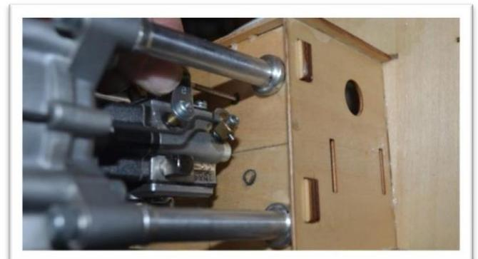
L'emplacement du servo des gaz dépend du moteur que vous choisissez d'utiliser. Le servo peut être monté à l'avant du fuselage dans de nombreux cas. (Si vous choisissez cet emplacement, percez 5 trous dans le haut du boîtier moteur afin que les vis de montage du servo et les vis du bras du servo soient accessibles.)
