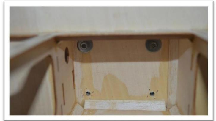
La distance entre la plaque d'appui de l'hélice et le pare-feu doit être de 6,3 po (160 mm). Cela fournira un espace entre le cône et le capot.
