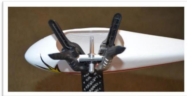
Percez les trous du train d'atterrissage et l'intérieur du pantalon de roue.
