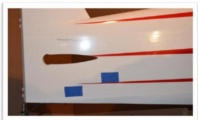
Faites glisser le stabilisateur horizontal à travers le fuselage en le poussant jusqu'au bout. Centrez-le d'un côté à l'autre à l'aide d'un ruban à mesurer.
