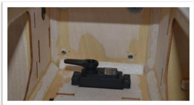
Le servo pourrait également être monté sur le côté pour le fuselage en ajoutant quelques morceaux de balsa dur ou épicié.
