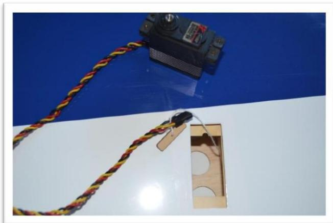
Fixez les extensions de fil aux câbles du servo à l'aide d'une pellicule rétractable ou d'un clip de sécurité.
