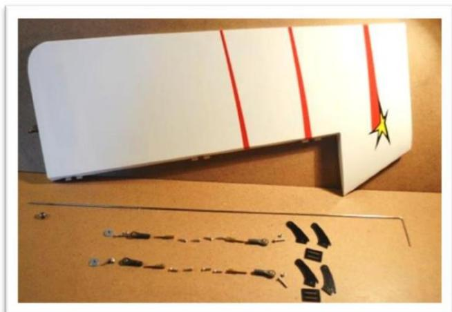
Le gouvernail est construit avec des fentes de klaxon de commande pour le système de commande push pull et le système de commande pull-pull. Les rubans bleus du peintre indiquent les emplacements des klaxons de commande. Les fentes du klaxon de commande pull-pull sont situées plus haut sur le gouvernail.
