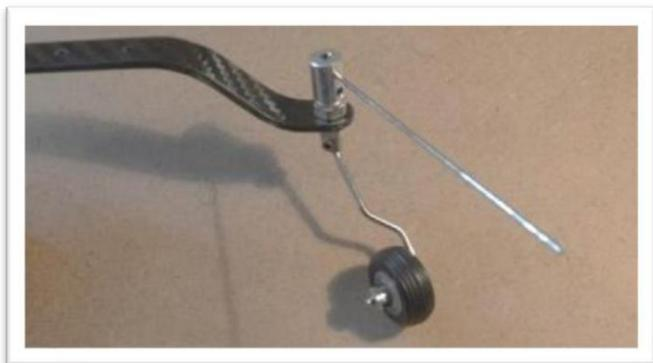
Utilisez les fixations du train d'atterrissage situées au bas du le fuselage ainsi que 2 rondelles plates situées dans l'ensemble du train d'atterrissage pour monter le train d'atterrissage en fibre de carbone. Ajoutez une goutte de frein-filet amovible aux vis pendant l'assemblage.
