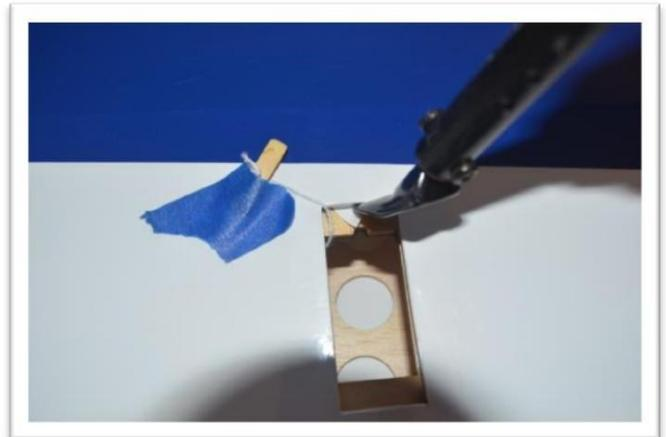
Localisez soigneusement les fentes des klaxons de commande des ailerons. Utilisez un fer à sceller pour coller le revêtement dans la zone où le klaxon de commande sera placé. Coupez le revêtement pour exposer les fentes. Faites attention à ne pas couper jusqu'au revêtement supérieur.
