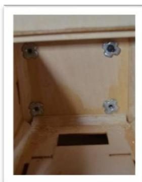
Utilisez des boulons et des rondelles de 4 mm pour fixer le boîtier du moteur à le mur coupe-feu. Appliquez du frein-filet amovible sur les boulons pendant l'assemblage.
