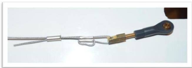
Retirez le jeu des câbles et assurez-vous que les câbles traverser une fois à l'intérieur du fuselage. Connectez les rotules au klaxon de commande du gouvernail.
