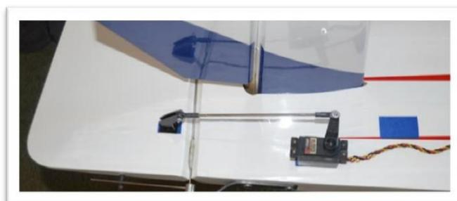
Les câbles pull-pull peuvent être retirés et le revêtement devra être réparé avec un revêtement ou un revêtement intelligemment placé.
