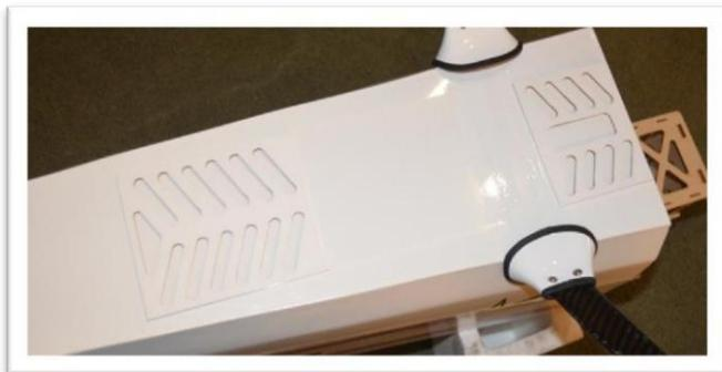
Si vous prévoyez d'utiliser un échappement de type cartouche, laissez le tunnel d'échappement ouvert. Installez les supports de tuyaux fournis dans la ventilation du tunnel et du fuselage.
