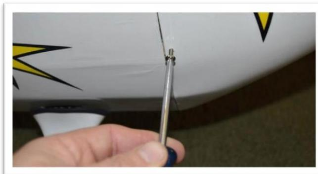
Appliquez une fine colle CA sur les languettes de montage et les trous de vis. (Laissez suffisamment de temps à la colle CA pour sécher avant de réinstaller le capot.)
