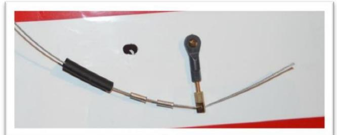
Faites une boucle autour de l'œillet du câble et repassez à travers un manchon d'écrasement.
