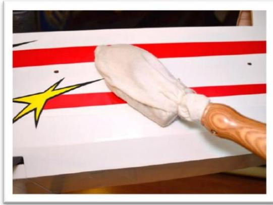
À 200-220°F (93-104°C), l'adhésif sur UltraCote® devient actif permettant de fixer le revêtement sur le modèle. Bien que 220° adhère complètement au revêtement au modèle, il est bien en dessous de la température qui fait rétrécir UltraCote®.
