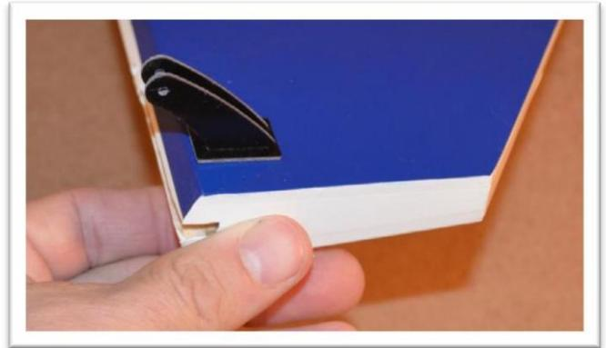
Avec le klaxon de commande en position, appliquez du ruban-cache pour peintre autour de la base du klaxon de commande. Placez le ruban jusqu'au bord de la base. Ni en dessous ni au-dessus.
