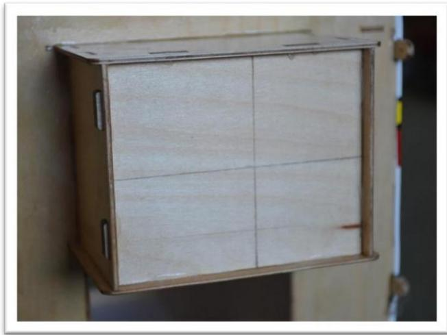
Utilisez le modèle DLE30 pour localiser les trous de montage du boîtier de montage du moteur électrique. Ce modèle utilise un motif de trous de 54 mm X 70 mm qui correspond au boîtier moteur.
