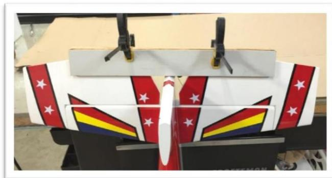
Retirez soigneusement le ruban « de masquage » avant que l'époxy ne durcisse complètement. Mais ne retirez pas le ruban adhésif au niveau du stabilisateur et du contrepois de l'élévateur jusqu'à ce que l'époxy soit complètement durci.
