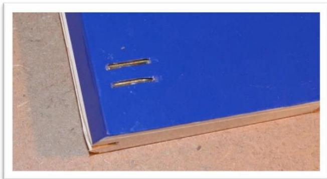
Testez l'ajustement des moitiés du klaxon de commande dans la fente individuellement, puis en tant qu'assemblage. L'ajustement doit être bien ajusté.
