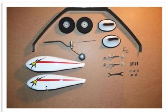
Utilisez les fixations du train d'atterrissage situées au bas du fuselage ainsi que 3 rondelles plates situées dans l'emballage du train d'atterrissage pour assembler le train d'atterrissage. Ajoutez une goutte de frein-filet amovible aux vis lors de l'assemblage.
