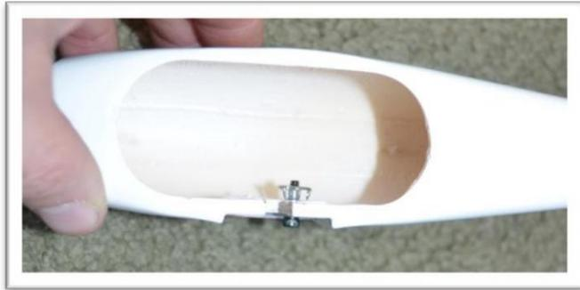
Faites glisser la roue sur l'essieu. Ajoutez le collier de roue et serrez la vis de réglage. Assurez-vous qu'il tourne librement. Mettez la roue et l'essieu dans le pantalon de roue, puis passez les filetages de l'essieu dans le train d'atterrissage.
