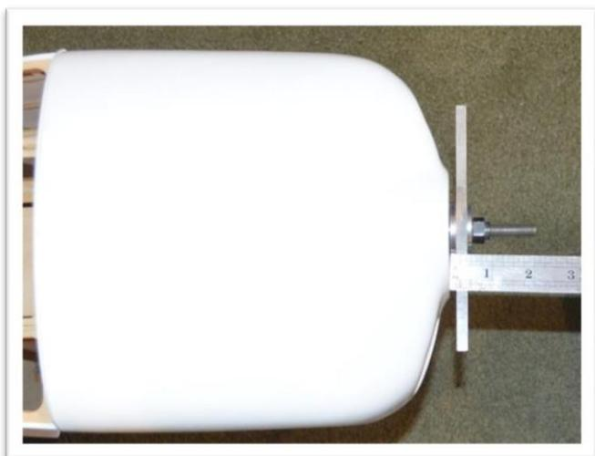
La plaque d'appui de l'hélice sera à environ 6,3 pouces (160 mm) du pare-feu du fuselage.
