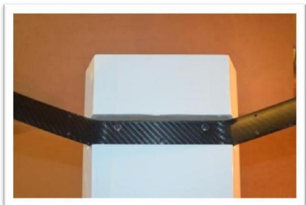
Placez le bloc de remplissage en bois sur le train d'atterrissage. Faites attention à l'ajustement car il est directionnel. Nous vous suggérons d'utiliser un morceau de revêtement blanc ou du ruban adhésif transparent pour maintenir le bloc de remplissage en position.
