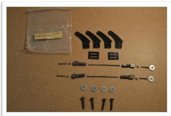
Testez l'ajustement des moitiés de klaxon de commande dans la fente, d'abord individuellement, puis en tant qu'ensemble. L'ajustement doit être bien ajusté.
