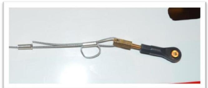
Ajustez les boucles et sertissez le manchon avec une pince à sertir ou la surface non dentelée d'une pince standard.
