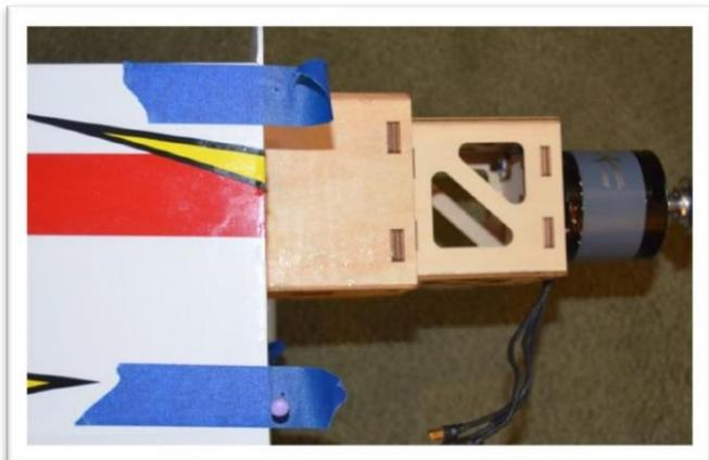
Retirez le ruban adhésif pour découvrir les languettes de montage et installez le capot. Collez le capot en place. Utilisez une épingle pour percer des trous dans le capot à travers les trous de localisation que vous avez créés dans le ruban. Faites pivoter la goupille pendant que vous la poussez à travers le capot. (Vous pouvez également utiliser un stylo pour marquer l'emplacement des trous sur le capot.)
