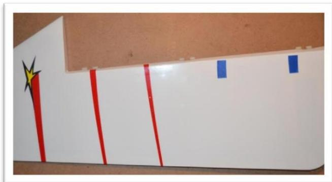
Coupez le revêtement du gouvernail pour exposer les fentes des guignols de commande des deux côtés du gouvernail, comme vous l'avez fait pour les ailerons et la gouverne de profondeur. Testez l'ajustement des guignols de commande, masquez la zone entourant les guignols de commande et utilisez une nouvelle lame de couteau et coupez le revêtement comme vous l'avez fait avec les ailerons et l'ascenseur.
