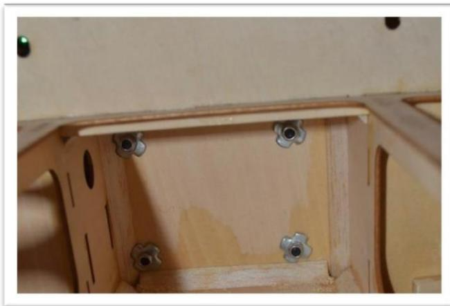
Utilisez un support en « X » avec un cercle de boulons de montage de 75 mm pour monter votre moteur. Utilisez les boulons et rondelles de 4 mm fournis. Ajoutez un frein-filet amovible lors de l'installation.
