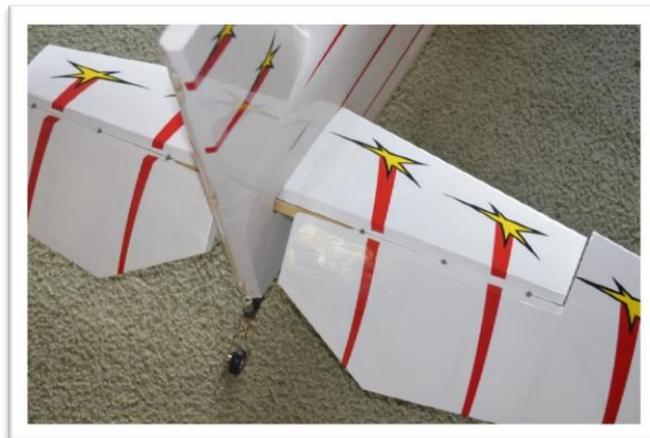
Fixez une rallonge de servo de 24 pouces sur le câble du servo de profondeur et utilisez une pellicule rétractable ou un clip de sécurité pour sécuriser la connexion.
