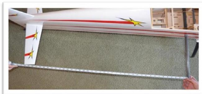
Une fois le stabilisateur horizontal positionné, collez-le en place avec de la colle CA fine. Mèche de colle des deux côtés, en haut et en bas.
