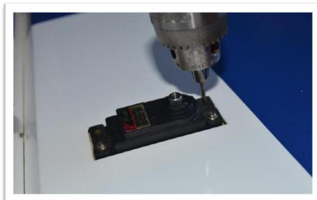
Réinstallez le servo. Assemblez une bielle et une rotule ainsi qu'une rotule d'aileron. Vérifiez la longueur de l'assemblage jusqu'au bras de servo avec le bord de l'aileron aligné avec l'aile. Une fois que la bonne longueur de l'assemblage est trouvée, connectez-la au bras de servo à l'aide de la rondelle et du contre-écrou des vis à métaux fournis. (Allumez l'émetteur, le récepteur et le servo tout en ajustant la bielle. Cela maintiendra le servo dans sa position correcte.)
