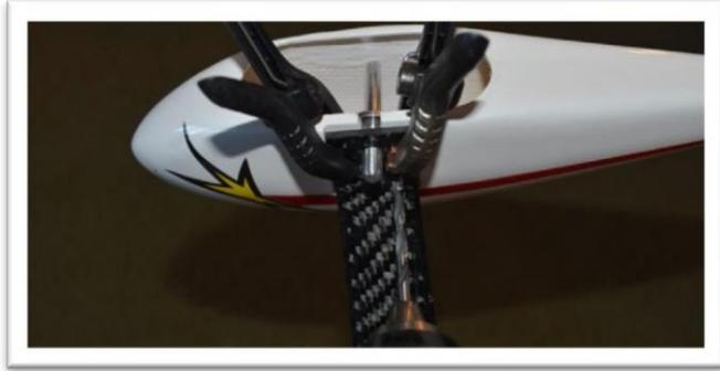
Utilisez une vis à métaux et une rondelle pour insérer un écrou borgne dans le pantalon de roue.
