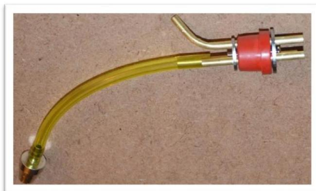
Insérez l'ensemble dans le réservoir de carburant et vérifiez que le cliquetis s'il est libre de se déplacer. Faites pivoter le réservoir d'un côté à l'autre et à l'envers pour garantir que le cliquetis ne reste pas coincé.
