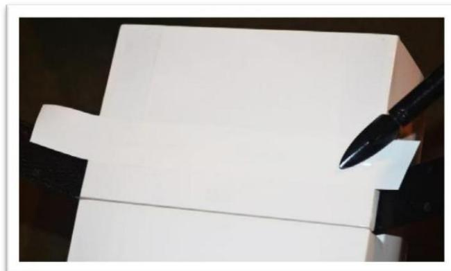
Installez les manchettes du train d'atterrissage avec les trous vers le bas de l'avion. Utilisez un tournevis à lame plate en tournant doucement pour aider à faire glisser le brassard sur le train d'atterrissage.
