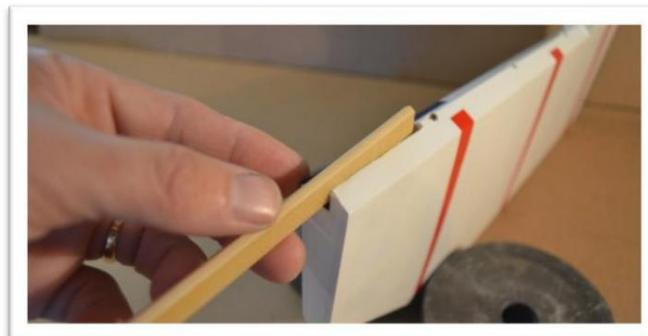
Insérez les axes de charnière dans les moitiés de l'élévateur et le stabilisateur horizontal. Vérifiez l'ajustement et l'écart au niveau de la ligne de charnière. Vous devrez peut-être ajuster les trous des charnières pour minimiser l'écart.
