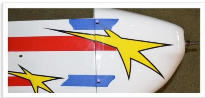
Retirez le capot et utilisez une perceuse de 3/32" pour ouvrir les trous de goupille. (Ou percez aux emplacements marqués.)
