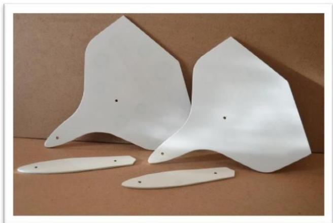
Les bouts d'ailes ont un écrou borgne installé sous le revêtement. Utilisez un couteau de loisir pour couper le revêtement. (Utilisez les trous d'une plaque d'espacement pour vous aider à localiser les trous dans le bout de l'aile.) Assemblez la plaque d'espacement et le générateur de force latérale sur l'aile avec les vis fournies et rondelles.
