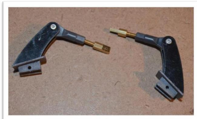
Les tests ajustent les guignols de commande aux fentes et les alignent avec la ligne de charnière. Les guignols de commande doivent être symétriques par rapport à la ligne charnière.
