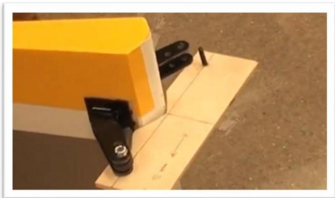
Une fois l'époxy complètement durci, installez le gouvernail sur le fuselage. Faites glisser la tige de barre de l'ensemble roue arrière à travers l'extrémité de la tige montée au bas du gouvernail. Alignez les charnières et faites passer le fil de charnière dans toutes les charnières.
