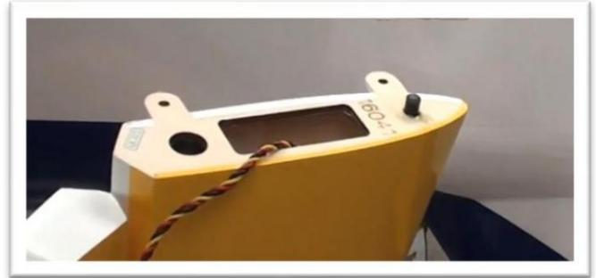
Faites glisser le tube du stabilisateur horizontal à travers le fuselage.
