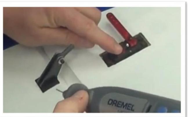
Assemblez la bielle à une rotule de servo avec la bride. Connectez ensuite la bielle à la rotule de la tige de commande. Notez qu'une extrémité est à gauche fil à main et l'autre est un fil à droite. Vissez la tige de connexion dans chaque maillon à rotule de manière égale.
