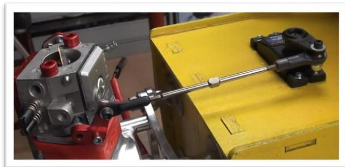
Les moteurs monocylindres peuvent nécessiter que la tige de commande du servo des gaz traverse le pare-feu puisque le carburateur se trouve généralement derrière le moteur. Vous pouvez utiliser la poche de servo située au bas du boîtier moteur avec le servo monté de l'intérieur ou vous pouvez envisager de créer votre propre emplacement de montage.
