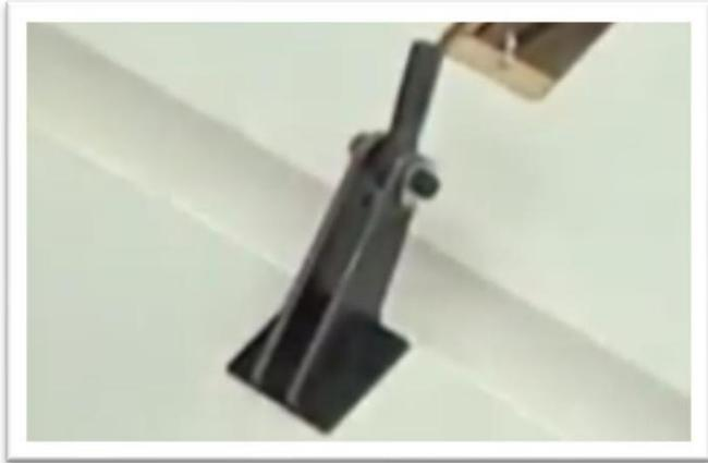
Vérifiez l'alignement du guignol de commande par rapport à la ligne centrale de la charnière. Le trou de liaison dans le guignol de commande doit être aligné avec l'axe central de la charnière.
