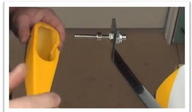
Testez l'ajustement de la roue et du pantalon de roue avec un collier de roue des deux côtés de la roue. Assurez-vous que la roue est centré et a un dégagement suffisant autour du pneu.
