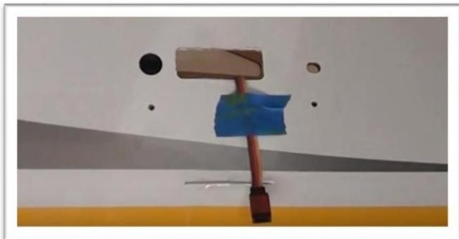
Appliquez quelques gouttes de colle CA fine sur la goupille d'alignement pour vous assurer qu'elle est bien fixée. (Laisser sécher avant de l'installer sur le fuselage.)
