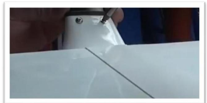
Installez les essieux dans le train d'atterrissage. Faites pivoter l'essieu de manière à ce que les méplats des vis de réglage du collier soient accessibles lorsque la roue le pantalon est installé. Fixez avec des contre-écrous en nylon.
