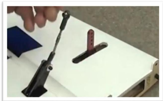
Vérifiez la longueur de l'ensemble avec le servo pour estimer la longueur. Lorsque vous vous approchez de la bonne longueur, connectez la rotule à bride au bras du servo avec une rondelle et une vis à tête creuse. (Ajustez toujours la longueur de la bielle avec le servo sous tension et centré.)
