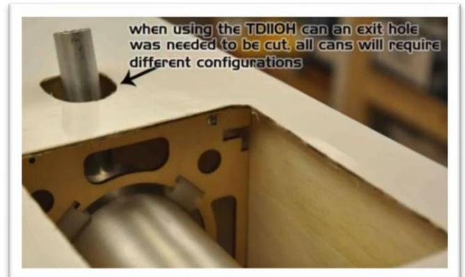
Assemblez la cartouche d'échappement avec le collecteur à l'aide de l'accouplement et des pinces. Assurez-vous de laisser un espace entre le collecteur et la cartouche à l'intérieur du couplage pour réduire les vibrations. Test d'ajustement dans le fuselage
