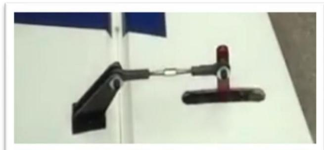
Ajustez la bielle pour aligner l'élévateur et le stabilisateur. Grâce aux filetages gauche et droit sur la bielle, la longueur de la bielle peut être ajustée sans la déconnecter du servo ou de la commande.
