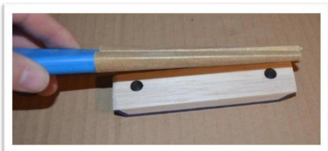
Le bloc de remplissage peut être maintenu en place avec des bandes de matériau de revêtement, du ruban d'emballage ou il peut être collé en place.
