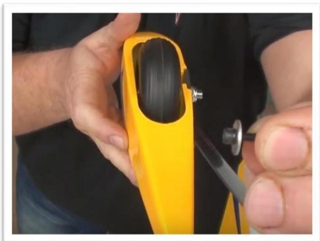
Prenez le temps de démonter complètement l'ensemble roue de queue puis remontez-le avec du frein-filet sur tous les pas de vis.
