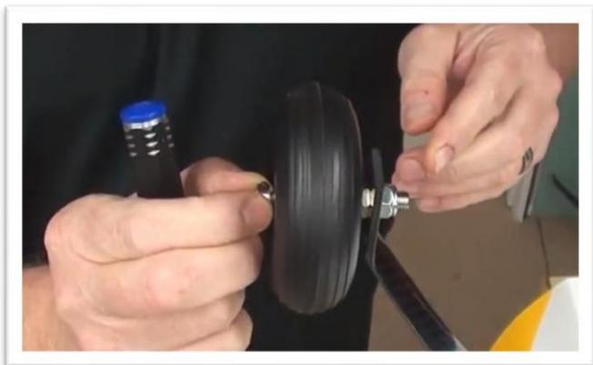
Montez le pantalon de roue sur le train d'atterrissage avec une rondelle et une vis à tête creuse. Nous vous recommandons d'utiliser un frein-filet sur ces vis.
