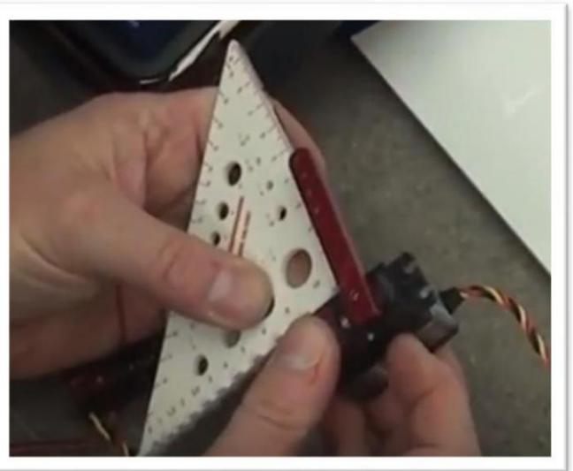
Connectez un fil d'extension de servo au fil du servo. Utilisez un clip de sécurité pour sécuriser la connexion. Fixez le fil d'extension du servo à la chaîne d'installation et tirez doucement le fil à travers l'aile pendant que vous insérez le servo dans l'aile.
