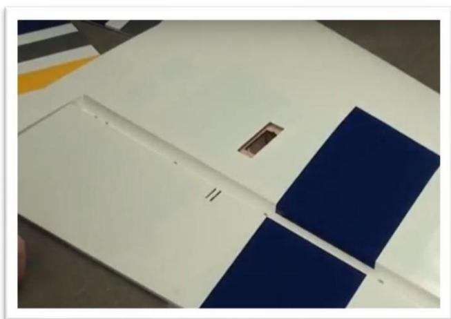
Localisez soigneusement les ouvertures du bras de servo de profondeur et les fentes de montage du klaxon de commande de profondeur. Utilisez un fer à souder pour fixer le revêtement autour de ces zones avant de le couper.
