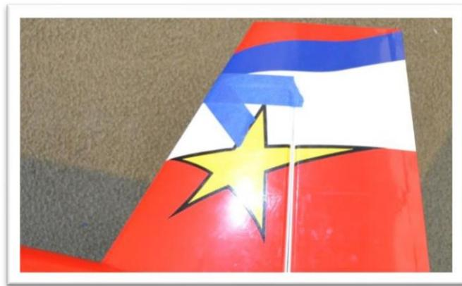
Répétez le processus d'installation des œillets de câble sur l'extrémité du gouvernail des câbles avec le servo sous tension et centré. Tirez fermement sur le câble. Vous n'avez pas besoin de serrer la corde de guitare.
