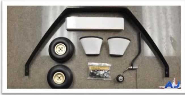
Installez le train d'atterrissage avec la partie la plus épaisse du profil aérodynamique vers l'avant. Utilisez une vis à tête creuse et une rondelle à travers l'extérieur et un contre-écrou en nylon à l'intérieur du fuselage.
