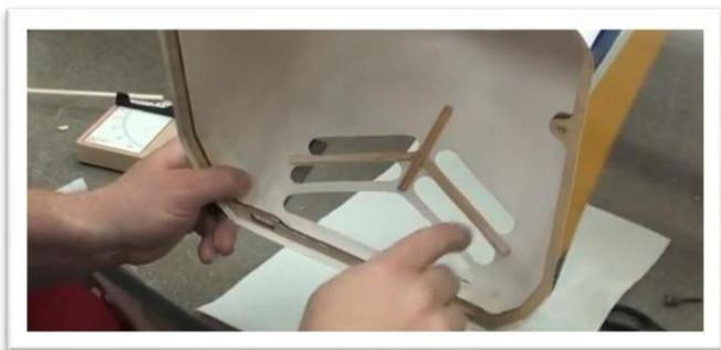
Au bord inférieur du pare-feu se trouvent 2 languettes qui serviront à monter le capot. Percez un trou de 1/8" au centre de chaque languette.
