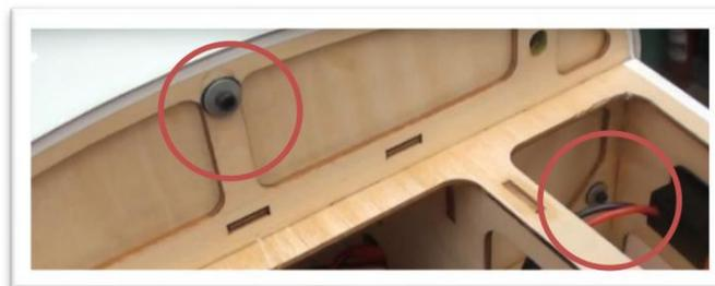
Dépliez les marqueurs de bande de position d'onglet que vous avez créés. Retournez le fuselage et percez des trous dans le capot pour les vis de montage. (Attention à ne pas percer les languettes et des noix aveugles. Installez 4 à 40 vis et rondelles pour terminer l'installation.)
