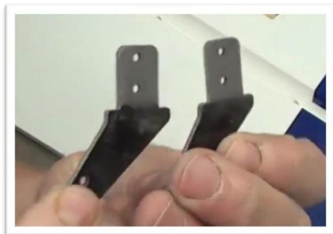
Testez l'ajustement du klaxon de commande dans la fente. Couper ou limer la fente au besoin pour obtenir un ajustement parfait. Assurez-vous que l'épaulement du klaxon de commande est bien appuyé contre la gouverne.
