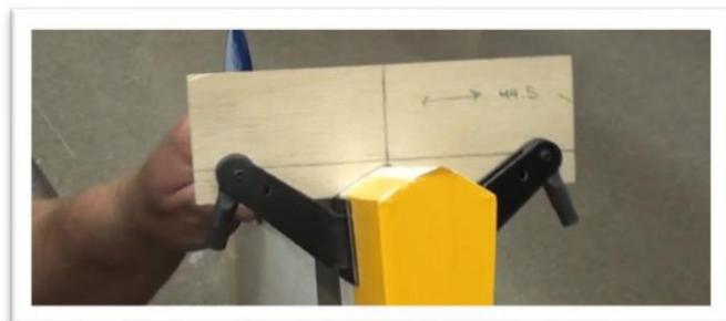
Utilisez de l'époxy 30 minutes pour fixer le klaxon de commande dans le gouvernail. Faites démarrer les klaxons de commande dans les fentes puis Appliquez de l'époxy sur la partie centrale des klaxons de commande.
