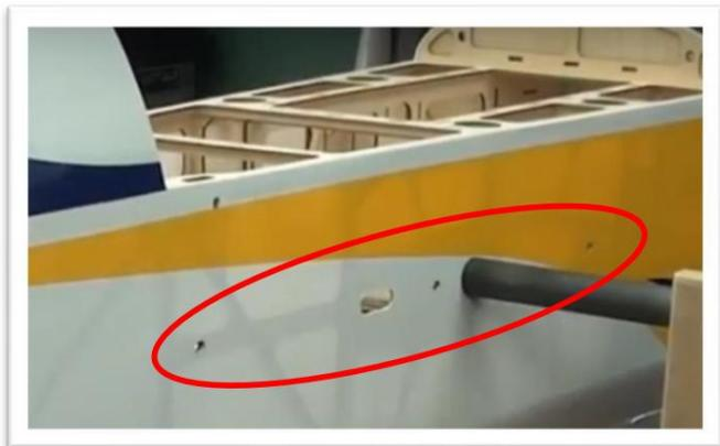
À la queue du fuselage, localisez les trous de montage du stabilisateur horizontal, le trou de la goupille d'alignement et les 2 trous de vis.
