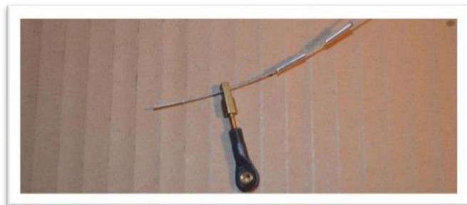
Faites une boucle autour de l'œillet du câble et repassez à travers un manchon d'écrasement.
