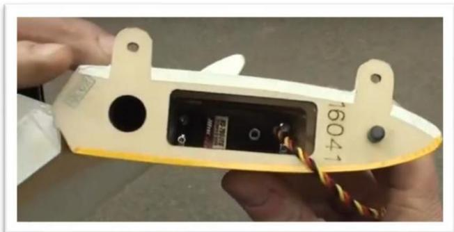
Connectez le servo à votre récepteur et à votre batterie. Allumez votre émetteur pour centrer le servo. Fixez le carré du bras du servo sur le côté du servo. N'oubliez pas de serrer la vis du bras de servo et le boulon de pincement si vous le bras de servo en a un.
