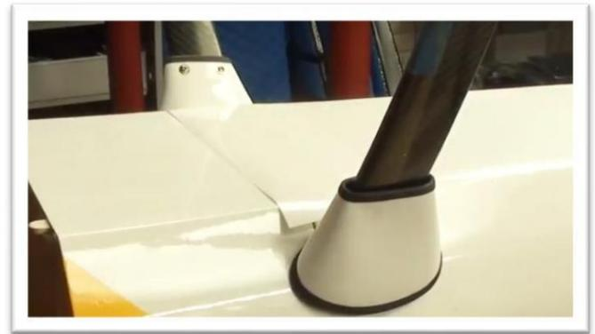
Faites glisser les poignets sur le train d'atterrissage et fixez-les avec des vis. Faites attention à ne pas casser les vis. Si la vis semble difficile à insérer, utilisez une perceuse pour ouvrir le trou. (Certaines personnes ont découvert qu'elles préféraient une couche de silicone à l'intérieur du brassard les maintient en place.)
