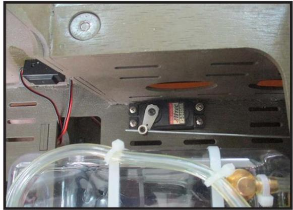
Réinstallez le klaxon du servo en faisant glisser le connecteur sur le fil de la tige de poussée. Centre le manche des gaz et le trim et installez le Klaxon de servo perpendiculaire à la ligne centrale du servo.
