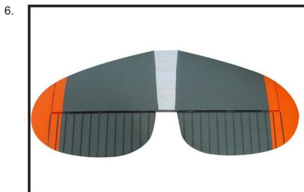
Lorsque vous êtes sûr que tout est correctement aligné, mélangez une quantité généreuse de 30 Minute Epoxy. Appliquez une fine couche sur le haut et le bas de la zone de montage du stabilisateur et sur les côtés de la plate-forme de montage du stabilisateur dans le fuselage. Faites glisser le stabilisateur en place et réalignez-le. Vérifiez à nouveau toutes vos mesures avant que l'époxy ne durcisse.
