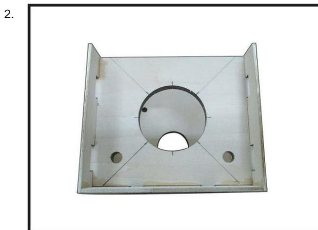
Fixez le support du moteur à l'avant du boîtier du moteur électrique à l'aide de quatre écrous borgnes de 5 mm et de quatre boulons à tête hexagonale M5x25 mm pour fixer le moteur.
