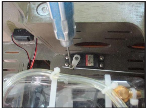
Déplacez le manche des gaz en position fermée et déplacez le carburateur en position fermée. Utilisez une clé hexagonale de 2,5 mm pour serrer la vis qui fixe le fil de la tige de poussée de l'accélérateur. Assurez-vous d'utiliser du frein-filet sur le visser afin qu'il ne vibre pas.
