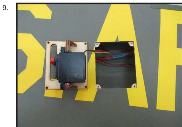
Mettez la trappe de l'aileron en place et utilisez un tournevis cruciforme pour l'installer avec quatre vis à bois.
