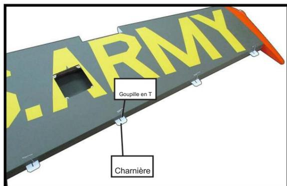
Faites glisser le panneau d'aile sur l'aileron jusqu'à ce qu'il n'y ait qu'un léger espace. La charnière est désormais centrée sur le panneau d'aile et l'aileron. Retirez les goupilles en T et serrez l'aileron contre le panneau d'aile. Un espace de 1/64" ou moins doit être maintenu entre le panneau de l'aile et l'aileron.
