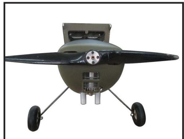
⚠ L'hélice ne doit toucher aucune partie du cône tournant. Si c'est le cas, coupez soigneusement l'ouverture du cône de rotation jusqu'à ce que l'hélice n'entre plus en contact avec elle.
