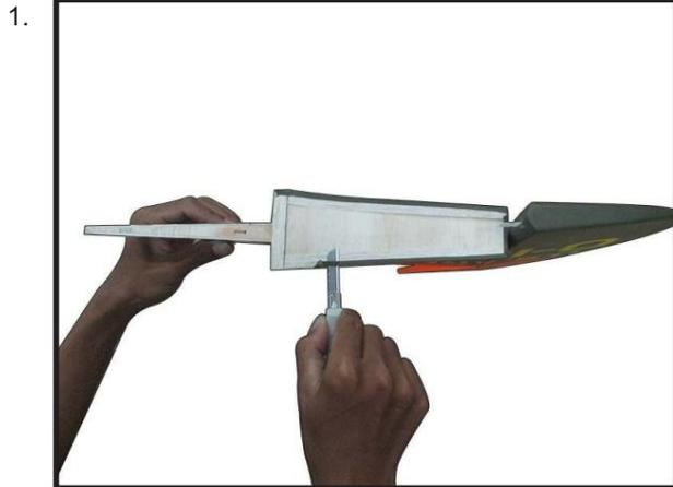
Faites glisser le stabilisateur vertical dans la fente située en haut du fuselage. Le bord arrière du stabilisateur doit être aligné avec le bord arrière du fuselage et la charnière inférieure du gouvernail doit s'engager dans la fente de charnière prédécoupée dans le bas du fuselage. Le bord inférieur du stabilisateur doit également être poussé contre le haut du stabilisateur horizontal.
