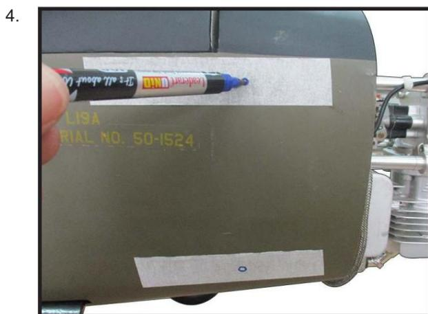
Utilisez une perceuse et un foret pour percer les trous pour les vis de montage du capot. Assurez-vous que la position du capot est correcte avant de percer chaque trou.
