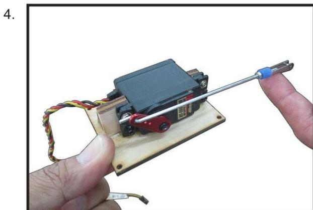
Fixez la tringlerie de recouvrement au klaxon de commande. Faites glisser le dispositif de retenue de chape sur les fourches de la chape.
