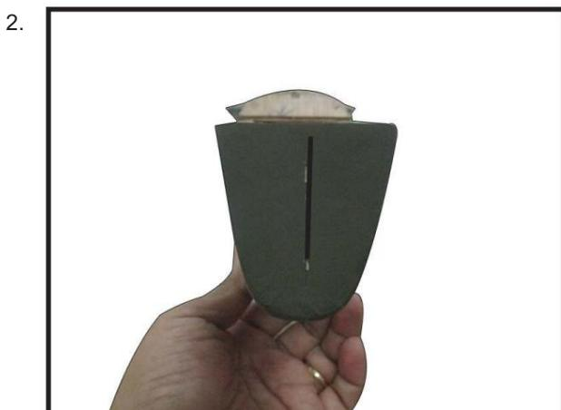
Tout en maintenant le stabilisateur vertical en place, utilisez un stylo et tracez une ligne de chaque côté du stabilisateur vertical à l'endroit où il rencontre le haut du fuselage.
