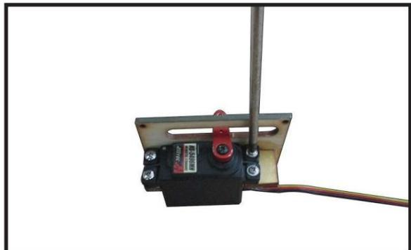
Appliquez 1 à 2 gouttes de C/A fin sur chacune des languettes de montage. Laissez le C/A durcir sans utiliser d'accélérateur.
