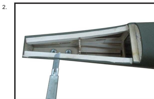
Faites glisser le stabilisateur en place dans la fente prédécoupée à l'arrière du fuselage. Le stabilisateur doit être poussé fermement contre l'avant de la fente.
