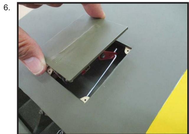
Acheminez le fil du servo du servo de tour vers l'emplanture de l'aile. Connectez le servo de tour au système radio. Avec le système radio allumé, placez le servo de tour en position.
