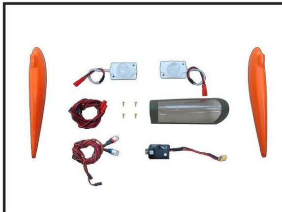
Un feu vert pour le bout de l'aile droite, deux feux blancs et le feu rouge pour le bout de l'aile laissée. ils sont conçus pour fonctionner sur des tensions de 12 volts. Connectez quatre lumières au circuit de commutation afin de pouvoir activer différents modes de cils en option.
