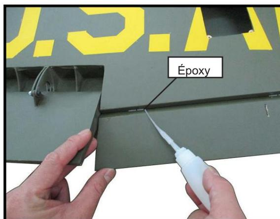
Retournez le panneau d'aile et dévissez l'aileron dans la direction opposée au côté opposé. Appliquez une fine colle C/A sur chaque charnière, en vous assurant que le C/A pénètre à la fois dans l'aileron et le panneau d'aile.
