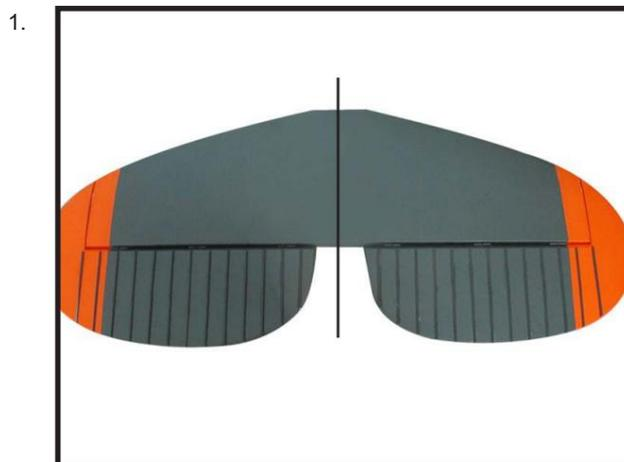
À l'aide d'un couteau à modeler, retirez soigneusement le revêtement de la fente de montage du stabilisateur horizontal (des deux côtés du fuselage).
