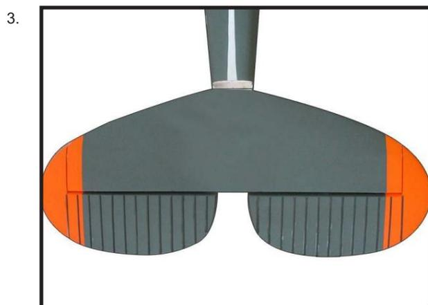
Une fois le stabilisateur fermement maintenu en place, utilisez un stylo et tracez des lignes sur le stabilisateur à l'endroit où celui-ci et les côtés du fuselage se rejoignent. Faites cela sur les côtés droit et gauche ainsi que sur le haut et le bas du stabilisateur.
