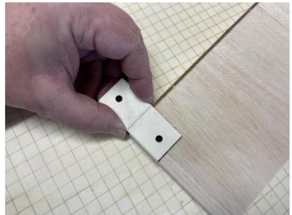
Marquez une ligne médiane sur la pièce de contreplaqué B10 et utilisez-la comme aide au perçage pour les vis à oreilles.
