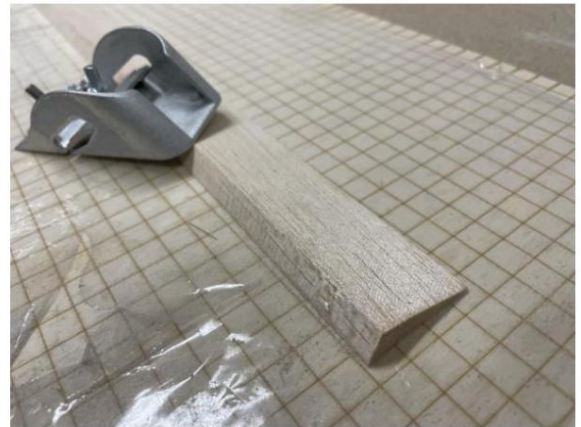
Marquez une ligne médiane sur la pièce de contreplaqué B10 et utilisez-la comme aide au perçage pour les vis à oreilles.
