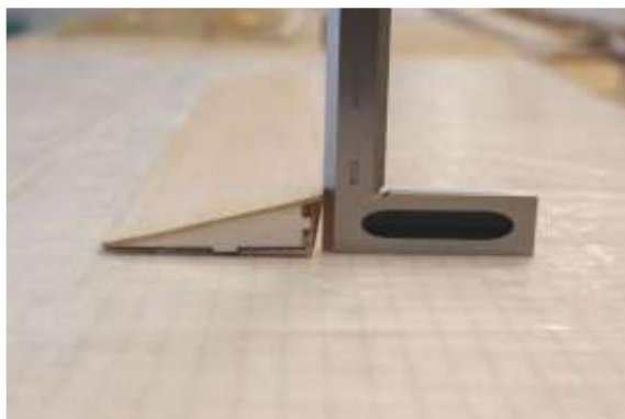
Poncer la bande supérieure/avant (M1/M2) de l'aileron à un angle d'environ 15° (vers le bas).
