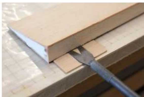
Fixez 4 encoches de charnière au volet d'atterrissage. Ces encoches sont situées juste au-dessus du revêtement inférieur.
