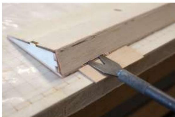
Fixez 4 encoches de charnière à l'aileron. Ces encoches sont situées juste en dessous du revêtement supérieur.
