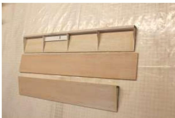
Collez les planches supérieures (balsa de 1,7 × 75 mm) pour les ailerons et les volets d'atterrissage.
