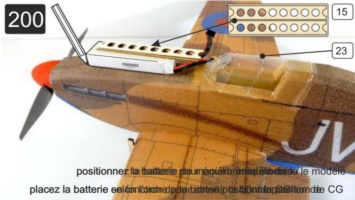
Sur l'avion, le fuselage est percé à l'avant de la batterie de sorte à ce que la plaque (15) s'insère dans la partie supérieure (à gauche) et la partie inférieure (à droite) de la batterie. Les trous sont percés à l'aide d'une perceuse à main. Marquez l'emplacement de la batterie avec un crayon.
