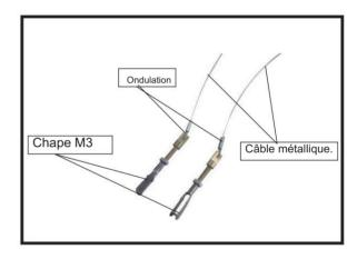
2) Fixez la chape à la languette en laiton à côté de la jambe de force interplan arrière sur l'aile supérieure-inférieure. Faites glisser un sertissage en cuivre sur le câble. Passez le câble à travers la languette en laiton sur l'aile supérieure, le dos à travers le sertissage en cuivre.
