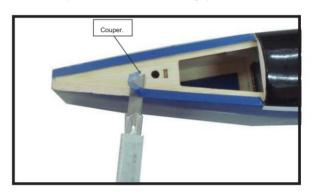
3 3) Faites glisser le stabilisateur en place dans la fente prédécoupée à l'arrière du fuselage. Le stabilisateur doit être poussé fermement contre l'avant de la fente.
