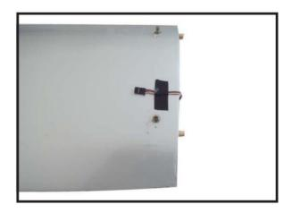
9) Mettez la trappe d'aileron en place et utilisez un Tournevis Phillips pour l'installer avec quatre bois des vis.
