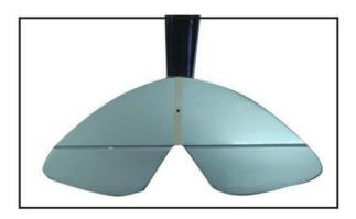
3 4) Le stabilisateur étant fermement maintenu en place, utilisez un stylo et tracez des lignes sur le stabilisateur à l'endroit où celui-ci et les côtés du fuselage se rejoignent. Faites cela sur les côtés droit et gauche et en haut et en bas du stabilisateur.
