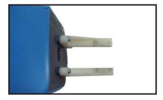
4) Sur le mur coupe-feu se trouve l'emplacement pour le tube de la tige de commande des gaz (pré-perçage).
