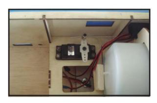
9) Déplacez le manche des gaz en position fermée et déplacez le carburateur en position fermée. Utilisez une clé hexagonale de 2,5 mm pour serrer la vis qui fixe le fil de la tige de poussée des gaz. Assurezvous d'utiliser du frein-filet sur la vis afin qu'elle ne se desserre pas par vibration.
