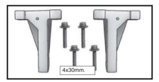
2) Utilisez quatre boulons à tête de 4x30 mm et quatre rondelles de 4 mm pour fixer les rails de montage du moteur au pare-feu. Serrer les vis . Assurez-vous d'utiliser du frein-filet sur les vis pour éviter qu'elles ne se desserrent par vibration.
