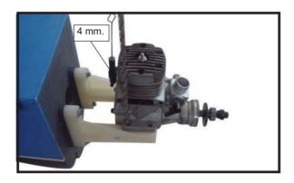
3) Utilisez une perceuse pour percer les quatre trous dans les rails de montage du moteur.
