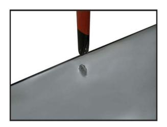
3) Répétez les étapes pour préparer le panneau d'aile restant pour l'installation et utilisez des pinces pour plier quatre des languettes en laiton à un léger angle. Faites le virage légèrement biaisé vers le plus grand trou de la languette.
