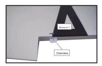
3 3) Faites glisser l'aileron sur le panneau d'aile jusqu'à ce qu'il n'y ait qu'un léger espace. La charnière est maintenant centrée sur le panneau d'aile et l'aileron. Retirez les goupilles en T et serrez l'aileron contre le panneau d'aile. Un espace de 1/64" ou moins doit être maintenu entre le panneau d'aile et l'aileron.
