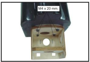
3) Fixez le moteur à l'avant du boîtier du moteur électrique à l'aide de quatre écrous aveugles de 4 mm et de quatre boulons à tête hexagonale M3x15 mm pour fixer le moteur.
