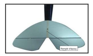
3) Faites glisser le stabilisateur vertical en place. À l'aide d'un triangle, vérifiez que le stabilisateur vertical est aligné à 90° par rapport au stabilisateur horizontal.
