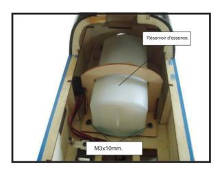
3 8) Utilisez un gabarit en contreplaqué pour maintenir en place le réservoir de carburant avec de la colle C/A pour fixer le réservoir de carburant à l'intérieur du fuselage.
