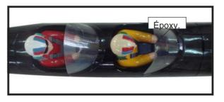
4) Positionnez la verrière sur le fuselage. Tracez autour de la verrière et sur le fuselage à l'aide d'un stylo-feutre.
