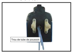
5) Faites glisser le tube de la tige de poussée dans le pare-feu et guidezle à travers le support du réservoir de carburant. Utilisez un C/A moyen pour coller le tube au pare-feu et au support du réservoir de carburant.
