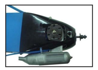
3 3) Installez le silencieux et l'extension du silencieux sur le moteur et faites une découpe dans le capot pour le dégagement du silencieux. Connectez les conduites de carburant et de pression au carburateur, au silencieux et au robinet de remplissage de carburant. Fixez le capot au fuselage à l'aide des vis M3x10mm.
