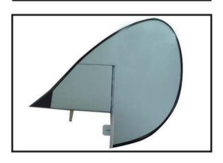
3 1) À l'aide d'un couteau à modeler, retirez le revêtement de la fente de charnière prédécoupée découpée dans la partie arrière inférieure du fuselage.
