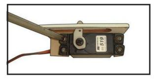
7) Appliquez 1 à 2 gouttes de C/A fin sur chacune des languettes de montage. Laisser le C/A durcir sans utiliser d'accélérateur.
