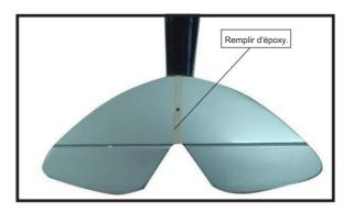
INSTALLATION DE L'AILERON VERITICAL
