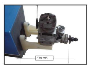
2) Utilisez une perceuse à broche et un foret de 4 mm pour percer une petite indentation dans le support pour la vis de montage du moteur.
