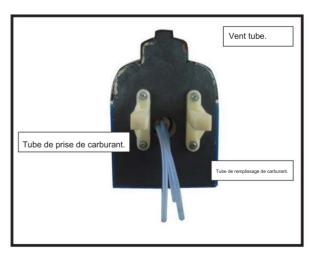
9) Connectez les conduites du réservoir au moteur et au silencieux. La ligne de ventilation se connectera au silencieux et la ligne du clunk au carburateur.
