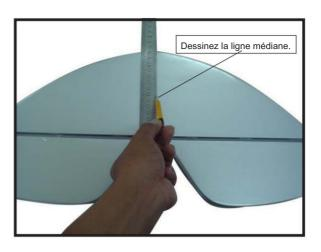
3 2) À l'aide d'un couteau à modeler, retirez soigneusement le revêtement de la fente de montage du stabilisateur horizontal (des deux côtés du fuselage).
