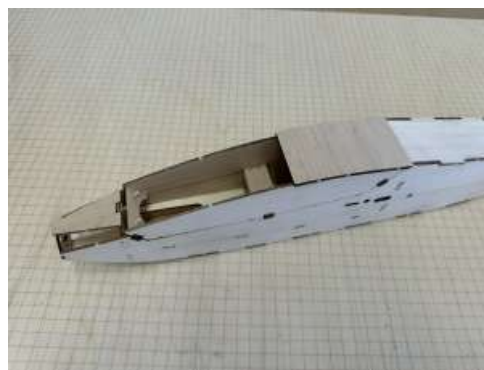
Coller les cales D3 sur les biseaux avant du fuselage (haut). Poncer d'abord la surface d'appui à plat
