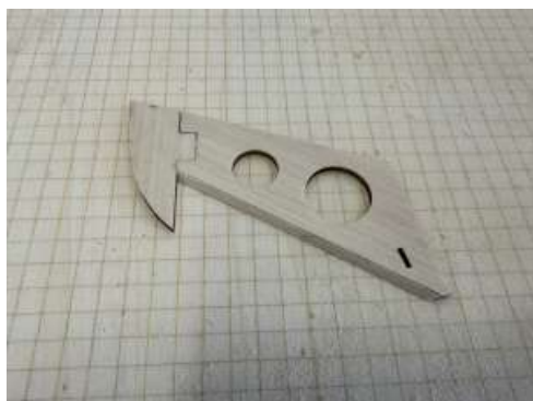
Chanfreiner obliquement le bord de la gouverne de direction B1 pour qu'elle puisse bouger librement
