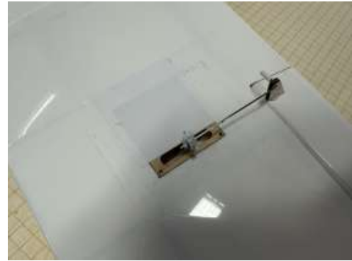
Chanfreiner obliquement le reste plus long du liteau triangulaire, puis le couper à la bonne longueur pour que l'aileron puisse bouger librement dans l'aile
