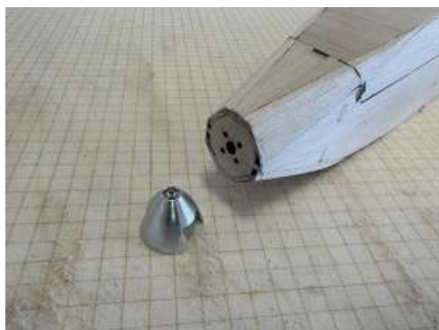
Tracer le cercle du spinner et poncer la pointe du fuselage
