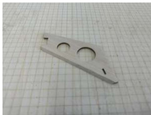
Chanfreiner obliquement le bord de la gouverne de profondeur B3
