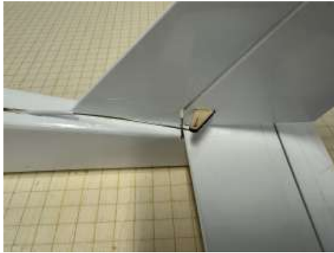
Coller le morceau de 160 mm du liteau triangulaire sur le bord de fuite
