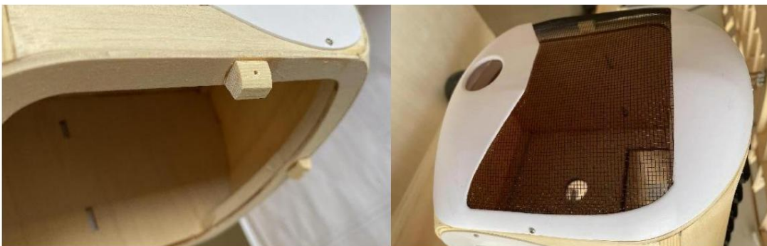
21) La cale en pin est fixée au nez pour fixer le capotage.
