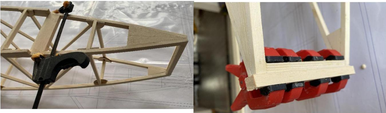
7) Collez des bandes de pin 6X6MM comme supports en diagonale de la queue.
