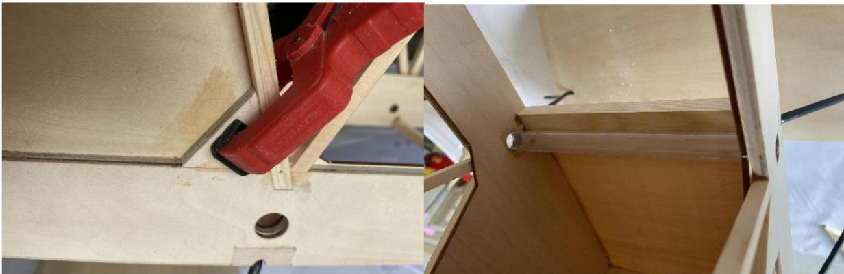
21) La cale en pin est fixée au nez pour fixer le capotage.
