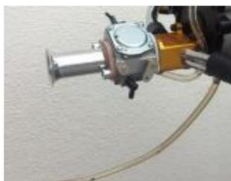
Sur cette photo on voit aussi le carter du tuyau de ventilation. Ce tube n'est pas bouché et laissez-le dans sa longueur d'origine !
