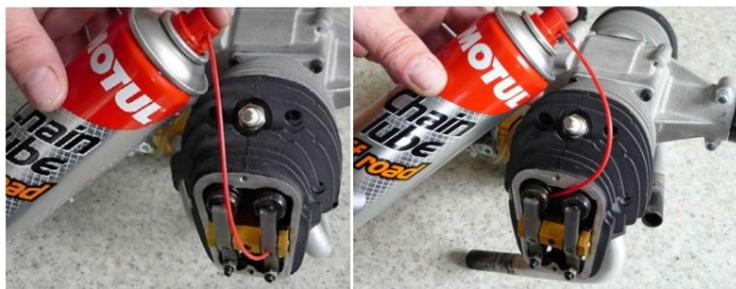
En même temps, ou du moins de temps en temps, il est nécessaire de vérifier la propreté du moteur, l'état/l'état de la batterie pour l'allumage et l'écart entre les électrodes de la bougie. Celui-ci doit être réglé sur 0,4 mm. Lorsque les électrodes sont brûlées, remplacez la bougie.
