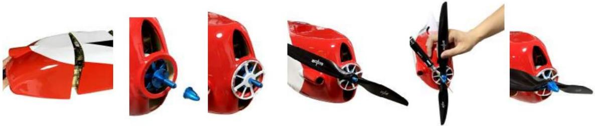
3. Fixez le cône avec des vis. Veuillez faire attention au fait que le cône doit être situé dans la position centrale du capot et que le bord du cône est parallèle au capot, l'écart est d'environ 1,5 mm.
