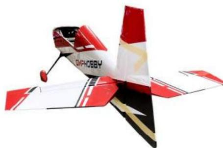
9. Trouvez la position centrale pour fixer le support de la roue arrière à gouvernail, percez un trou, fixez le support de la roue arrière avec des vis. (Pas besoin de le visser complètement)
