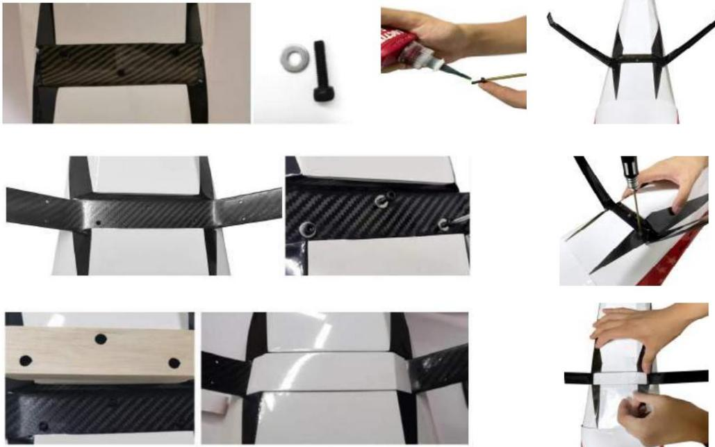
5. Faites glisser les poignets sur le train d'atterrissage et fixez-les avec des vis.
