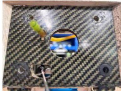
11. Le trou du tuyau d'huile doit être agrandi et un cercle de du ruban électrique est enroulé autour de l'extérieur pour protéger le tuyau d'huile.
