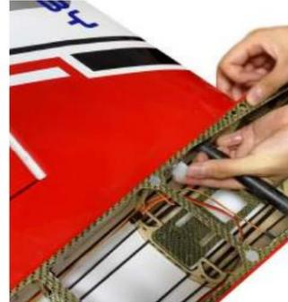
10. Dévissez les vis de fixation sur l'aile, installez le bout de l'aile.
