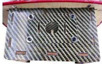
14. Collez le masking tape sur le fuselage, et utilisez un marqueur stylo pour marquer la position de la vis de fixation du capot, le capot doit être enclenché en place, sinon cela pourrait provoquer une installation imprécise
