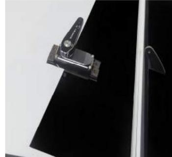
6. Fixez le bras de servo d'aileron et les bras de commande avec la rotule tirez la tige, placez la vis hexagonale à tête cylindrique, le joint, la tête sphérique sur le bras du servo, fixez-la avec une pince en fer, ajustez les tiges de traction à tête sphérique à la bonne longueur.
