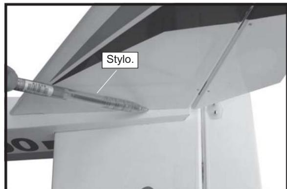
.13) Retirez le stabilisateur vertical. À l'aide d'un couteau à modeler, retirez le revêtement sous les lignes que vous avez tracées. Retirez également le revêtement du bord inférieur du stabilisateur et des bords inférieur et supérieur du bloc de remplissage. Laissez le revêtement en place sur les côtés du bloc de remplissage.
