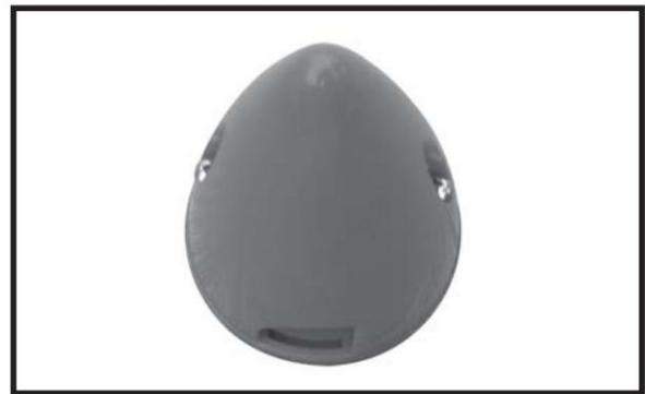
Installez la plaque arrière du cône, l'hélice et le cône du cône. Le cône tournant est maintenu en place à l'aide de deux vis à bois de 3 mm x 12 mm.
