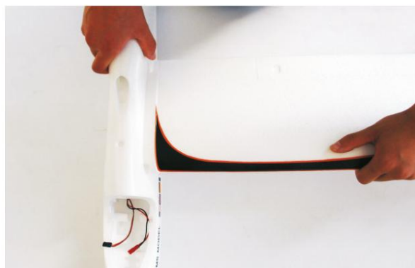
2. Insérez la moitié de l'aile gauche dans le fuselage.
