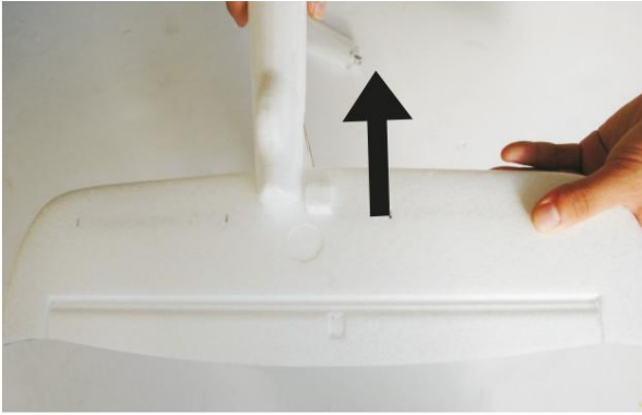
6. Installez et alignez l'empennage en suivant les flèches.
