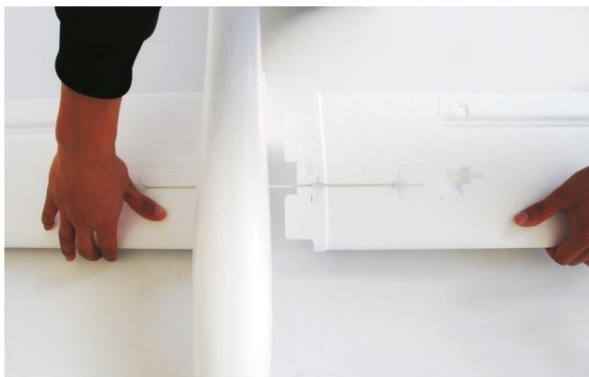
3. Insérez le panneau de l'aile droite dans le fuselage.
