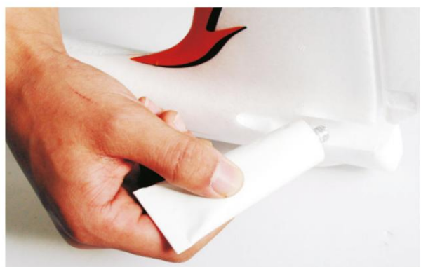
5. Enduisez la surface de contact sur la queue verticale avec de la colle. Veuillez noter les détails sur le collage plus loin dans les instructions.
