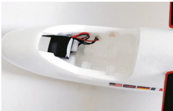
9. Position de la batterie LiPo dans la cabine.
