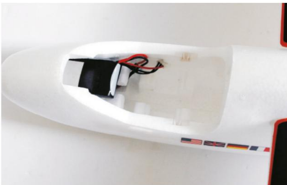
9. Emplacement de la batterie LiPo dans la cabine.
