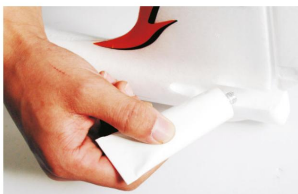
5. Appliquez de la colle sur la surface de contact de l'aillette. Notez les détails sur le collage plus loin dans les instructions.
