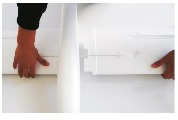
3. Insérez la moitié de l'aile droite dans le fuselage.
