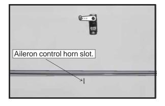
☐ 4) Insert aileron control horn to the aileron.
