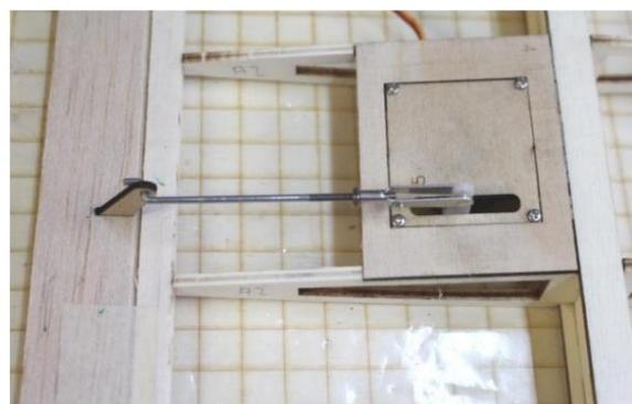
Plier (sertir) le fil au niveau du marquage 2x 90° pour une connexion en Z. Coupez la longueur de câble en excès et accrochez le connecteur Z dans le guignol de commande.
