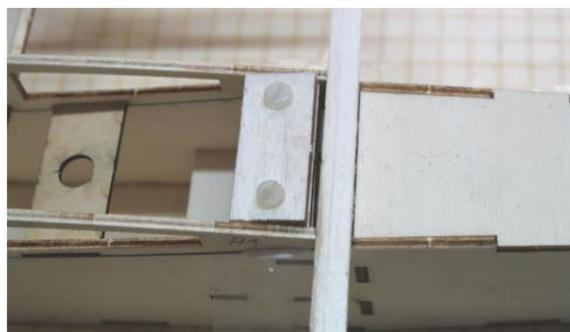
Mettez l'aile sur le fuselage. Faites glisser le bloc entre les deux nervures du milieu (A1). Si le siège est OK, bien coller la cale entre les nervures (A1). Ne collez jamais le bloc au fuselage, si nécessaire placez des petits morceaux de papier d'aluminium entre les deux !
