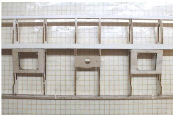
Collez le cadre de montage du servo (J4/J1) et le passe-câble (J6) sous l'aile.
