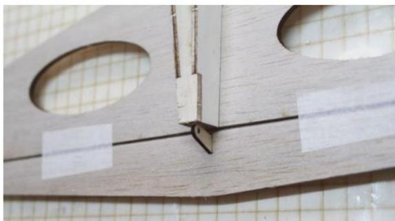
Insérez l'empennage dans le fuselage.
