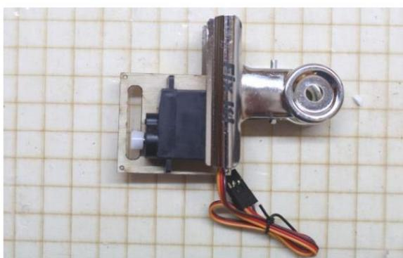
Collez le servo d'aileron sur le couvercle (J5) avec de l'époxy 5min.
