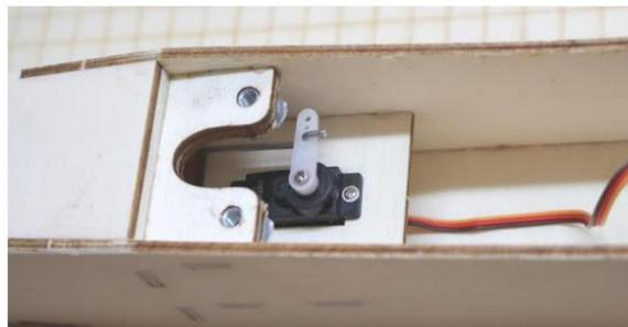
Insérez la tringlerie par l'arrière dans le fuselage
