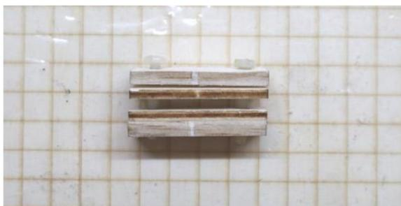
Collez le bloc pour la connexion à vis à ailettes de (F3, A5, E1 et F3). Les deux parties en contreplaqué se trouvent au milieu entre les parties en balsa. Utilisez des vis M4 pour le centrage.
