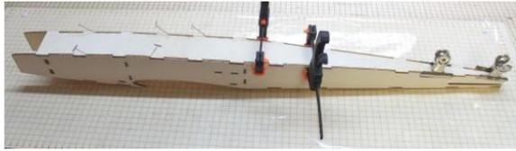
Retournez le fuselage, insérez et collez le bordé inférieur du fuselage (D2).
