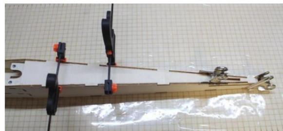
Insérez et collez la colonne vertébrale supérieure arrière du fuselage (D1). Le dessous des deux parties latérales doit reposer sur le panneau de construction.
