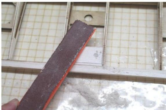
Retirez l'aile du fuselage et poncez les parties saillantes du bloc des deux côtés en fonction de la forme du profil.
