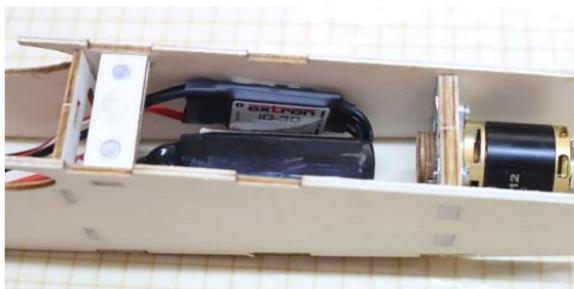
Fixez le contrôleur à un panneau latéral du fuselage avec du ruban adhésif double face ou du velcro.
