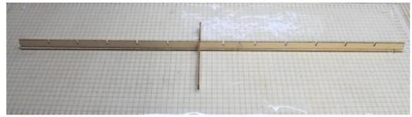
Agrafez le longeron principal inférieur (B4) directement sur le panneau de construction. Collez-y le peigne à côtes (C2) au milieu. Insérez une côte comme test et, si nécessaire, Alignez le peigne à côtes en conséquence.
