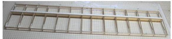
Collez le longeron principal supérieur (B4), le bord d'attaque auxiliaire (G2) et le bord de fuite auxiliaire (G1).
