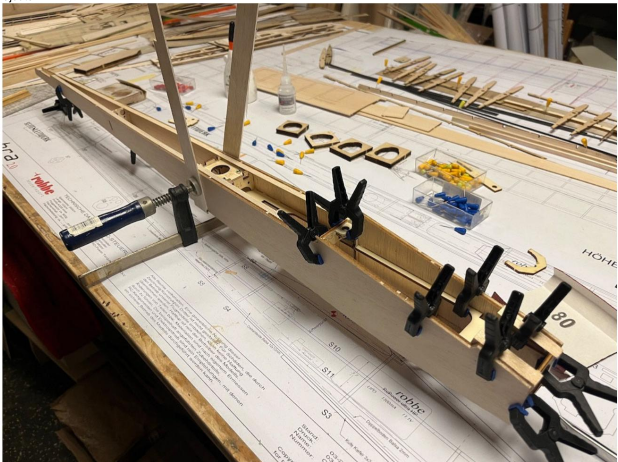
Les cadres S6 et S7 sont situés dans la poutre du fuselage.
