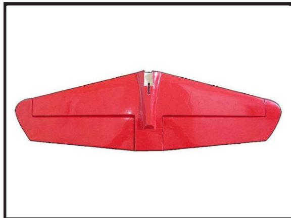
2) À l'aide d'un couteau à modeler, retirez soigneusement le revêtement de la fente de montage du stabilisateur horizontal (des deux côtés du fuselage).
