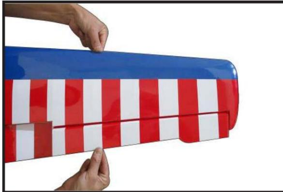
3 5) Retournez le panneau d'aile et déviez l'aileron dans la direction opposée du côté opposé. Appliquez une fine colle C/A sur chaque charnière, en vous assurant que le C/A pénètre à la fois dans l'aileron et le panneau d'aile.
