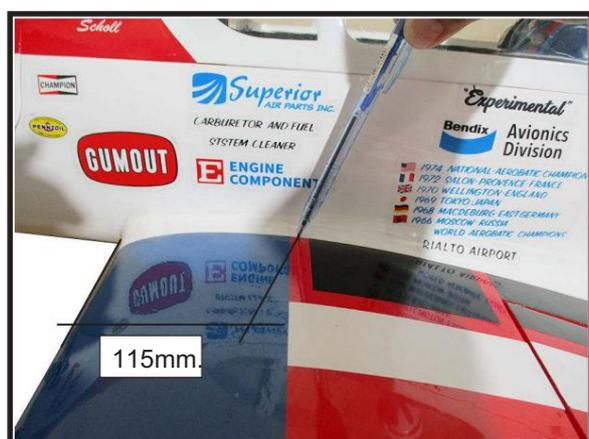
\*Si possible, essayez d'abord d'équilibrer le modèle en changeant la position de la batterie du récepteur et du récepteur. Si vous ne parvenez pas à obtenir un bon équilibre, il sera alors nécessaire d'ajouter du poids au nez ou à la queue pour atteindre le bon point d'équilibre.
