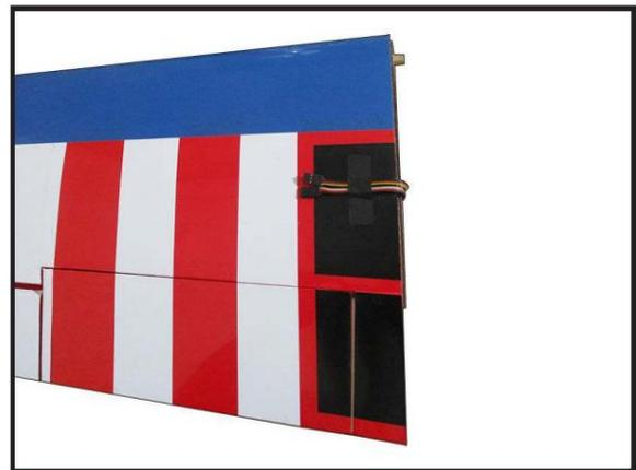
8) Mettez la trappe de l'aileron en place et utilisez un tournevis cruciforme pour l'installer avec quatre vis à bois.
