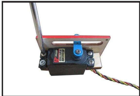
6) Appliquez 1 à 2 gouttes de C/A fin sur chacune des languettes de montage. Laissez le C/A durcir sans utiliser d'accélérateur.
