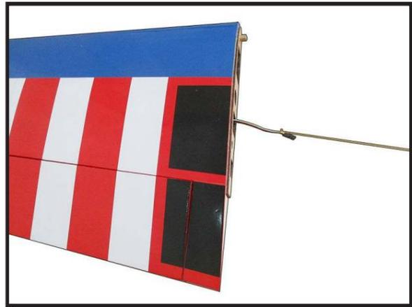
7) Retirez la corde de l'aile à l'emplacement du servo et utilisez le ruban adhésif pour la fixer au câble d'extension du servo. Tirez le fil à travers l'aile et retirez la ficelle.
