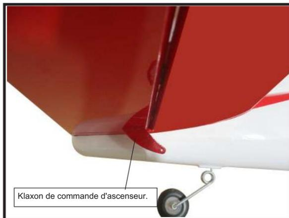
3 3) Vissez une chape et un contre-écrou M2 sur chaque tige de commande d'ascenseur. Enfilez les cornes jusqu'à ce qu'elles affleurent les extrémités des tiges de commande.
