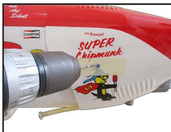
Utilisez une perceuse et un foret pour percer les trous pour les vis de montage du capot. Assurez-vous que la position du capot est correcte avant de percer chaque trou.
