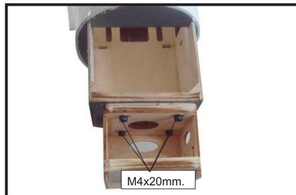
3) Fixez le moteur à l'avant du boîtier du moteur électrique à l'aide de quatre écrous borgnes de 3 mm et de quatre boulons à tête hexagonale M3x15 mm pour fixer le moteur.
