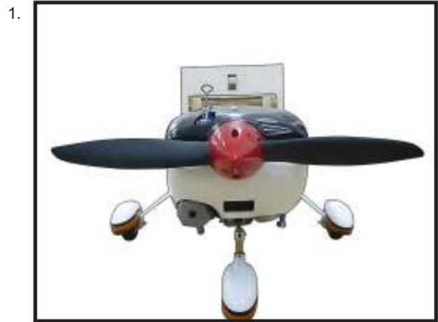
⚠ L'hélice ne doit toucher aucune partie du cône du cône. Si c'est le cas, utilisez un couteau à modeler bien aiguisé et coupez soigneusement le cône du cône à l'endroit où l'hélice entre en contact avec lui.
