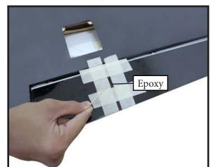
**INSTALLING THE AILERON SERVOS**
