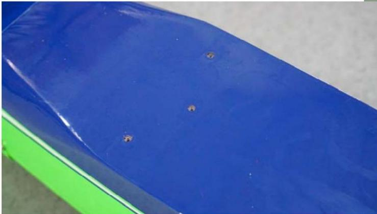
3. Alignez le train d'atterrissage sur les emplacements des trous et serrez les trois vis. L'application de frein-fil est fortement recommandée.
