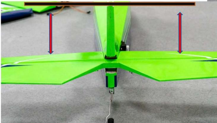
2. Insérez le tube de carbone des ailes principales dans le fuselage pour vous assurer que le stabilisateur horizontal est parallèle au tube de carbone.
