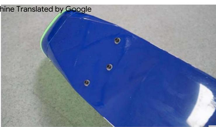
1. Les vis de montage du train d'atterrissage sont installées sur le fuselage pour éviter les pièces manquantes.
