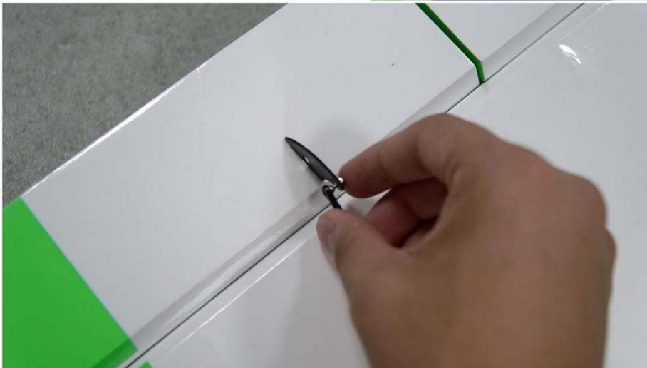
3. Ajustez la longueur de la biellette en tournant les rotules dans les positions appropriées.
