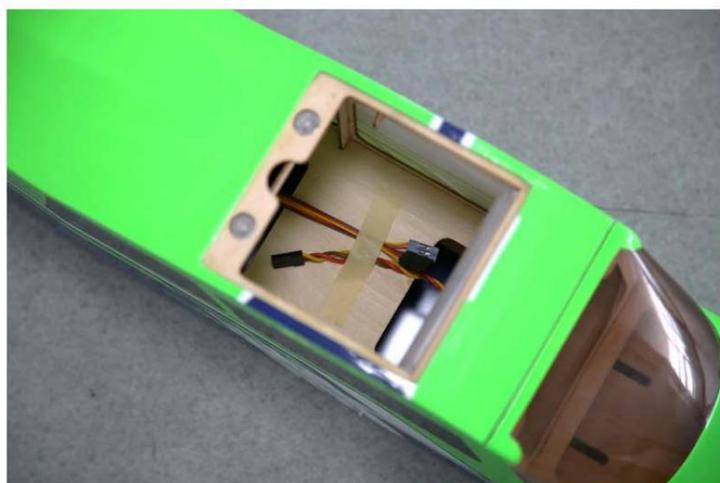
\*Câbles de servo enregistrés pour un accès facile. \*Le capot est installé en usine.
