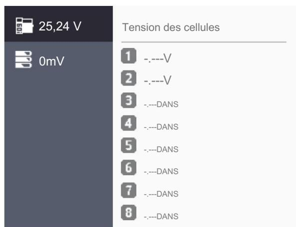
Lorsque le XT60i se connecte à une batterie normale, le BG-8S affiche uniquement la tension totale, le port d'équilibre doit être connecté pour vérifier la tension de chaque cellule.
