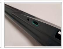
Pour la connexion du servo à l'aile, fraisez un trou pour le connecteur à 6 broches devant la goupille de torsion arrière. Le connecteur peut être collé en place ou installé sans serrer. Une installation fixe est plus complexe au début, mais vous fera gagner du temps et des nerfs plus tard lorsque vous installerez le modèle sur le terrain de vol.
