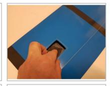
Poncez légèrement et nettoyez la surface dans les puits de servo pour assurer une bonne adhérence avec 10-Min Epoxy.
