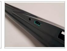
Pour le connecteur du servo à l'aile, fraisez un trou pour le connecteur à 6 broches devant la goupille de torsion arrière. Le connecteur peut être fermement collé ou installé sans serrer. Une installation fixe est initialement plus complexe, mais permet ensuite d'économiser du temps et des nerfs lors de la mise en place du modèle sur l'aérodrome.
